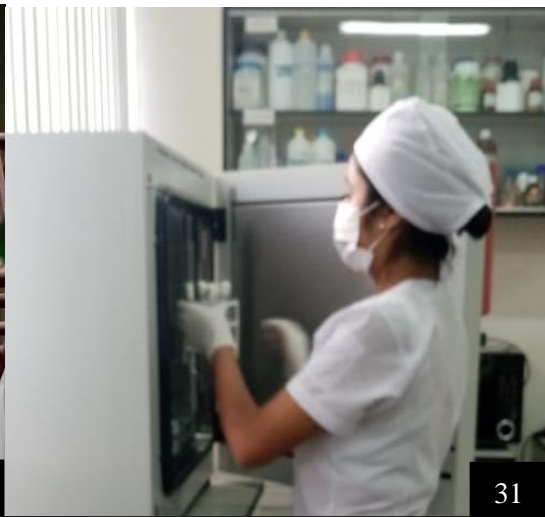
Img: 31. Incubación por 12 horas a 36°C
