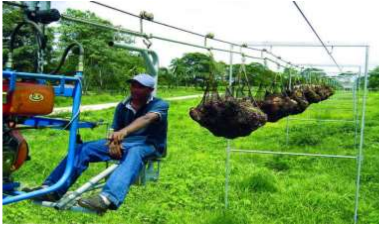
Figura 36. Método de halamiento con el uso de un motor. Fuente: Maury (2018).
