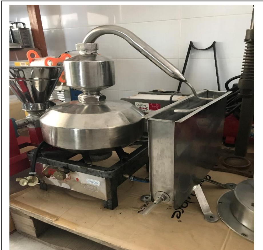
Figura 7. Alambique que se usó para la extracción de A.E. del fruto de molle por arrastre de vapor.
