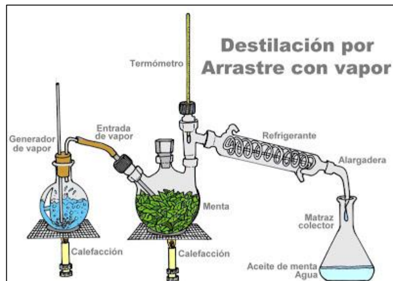
Figura 3. Destilación de arrastre con vapor.
