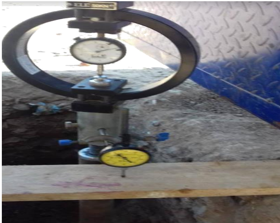
Fotografía N° 9 - Colocación de los diales fuerza y dial de penetración
