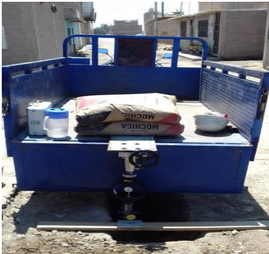
Fotografía N° 6 – Colocacion de la moto card para empezar el ensayo CBR in situ
