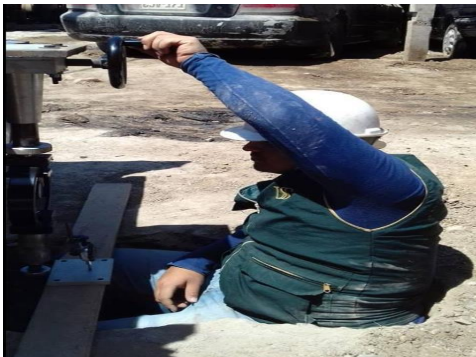
Fotografía N° 12 – Realización del ensayo CBR in situ
