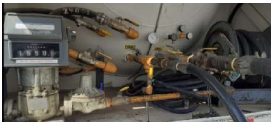
Figura 4. Válvula de vapor, válvula de líquido, Contometro de presión y Contometro de temperatura. (Fuente propia)
