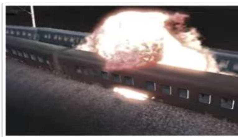
Figura 1. Explosión de dos trenes por causa de una fuga de GLP (Tauseef et al., 2007)
