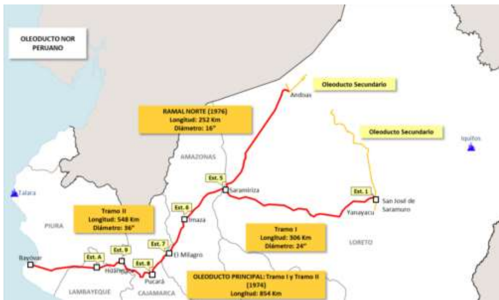
Figura 10: Esquema del Oleoducto Norperuano
