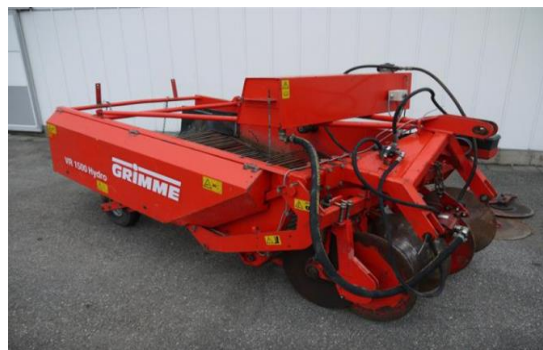
Figura 20. Cosechador de papas de dos surcos, con hidrobomba.
