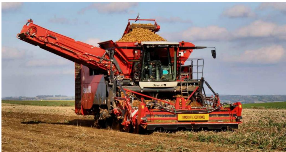
Figura 2. Cosechadora de papas autopropulsada.
