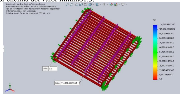
Figura 77. Estudio de Análisis Estático - Factor de Seguridad.
