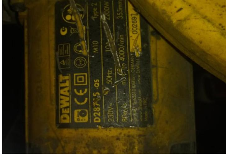
*Figura 25.* Placa característica del motor de la tronadora
