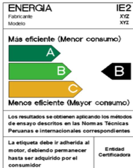
**Figura 16.** Eficiencia energética en motores AC
