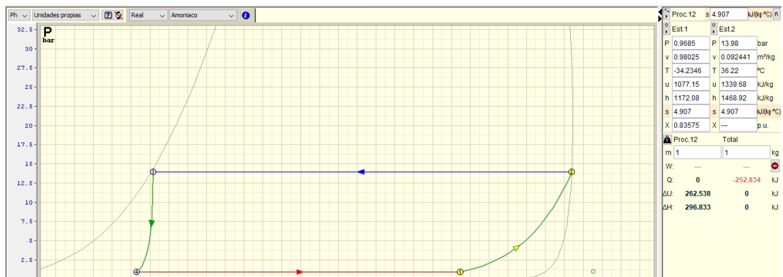
Figura 23- Ciclo termodinámico del proceso 1 a 2 en el programa Termograf.
