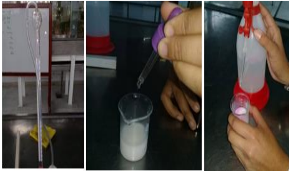
Figura 26: Para determinar la acidez de la leche, se necesita 20 mL de leche en un beaker, luego se agrega 5 gotas de fenolftaleína y finalmente se incorpora NaOH hasta que la muestra de leche vire (rosa).
