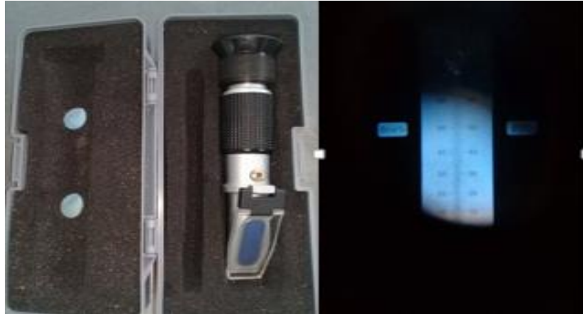
Figura 28: A través del Brixómetro se realizó la lectura de grados °Brix de la leche.
