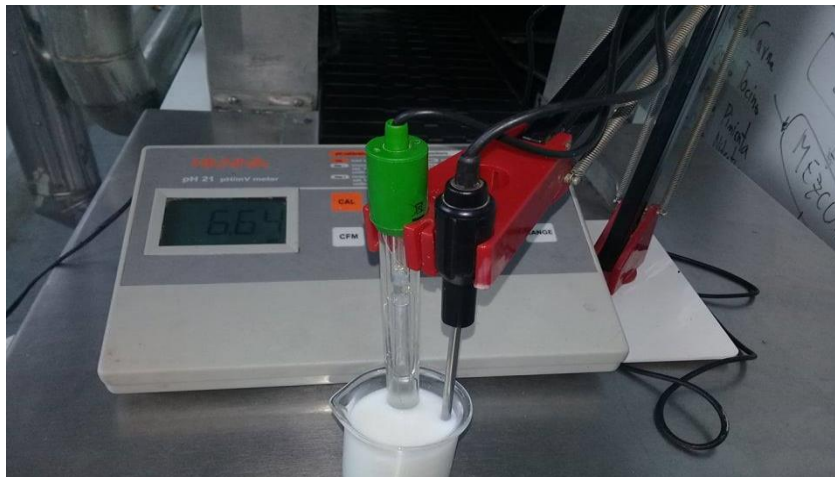
Figura 27: Para determinar el pH, se empleó el potenciómetro en una muestra de leche de 100 mL.
