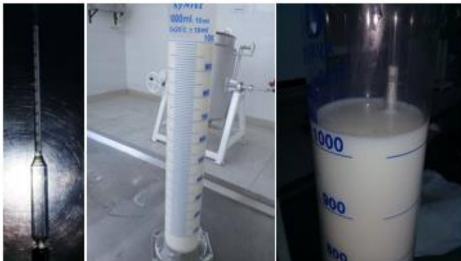
Figura 25: Para medir la densidad se emplea una probeta con 100 ml de leche y un lactodensímetro de modo que cuando este flote se tomó lectura la cual fue 1.030 g/cm 3
