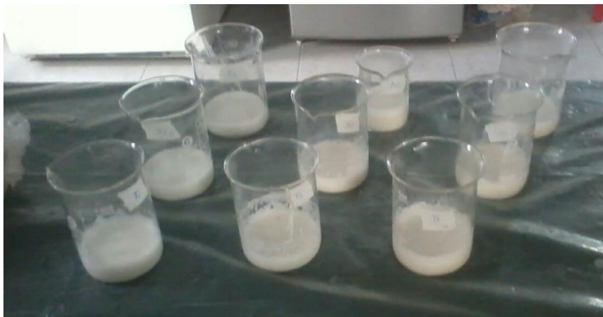
Figura 23: Se pesa los 3 tipos de gomas a diferentes concentraciones cada una (2gr, 3gr y 4gr) para poder determinar si son solubles en leche, su grado de viscosidad y la afinidad de una goma con otra en diferentes porcentajes.
