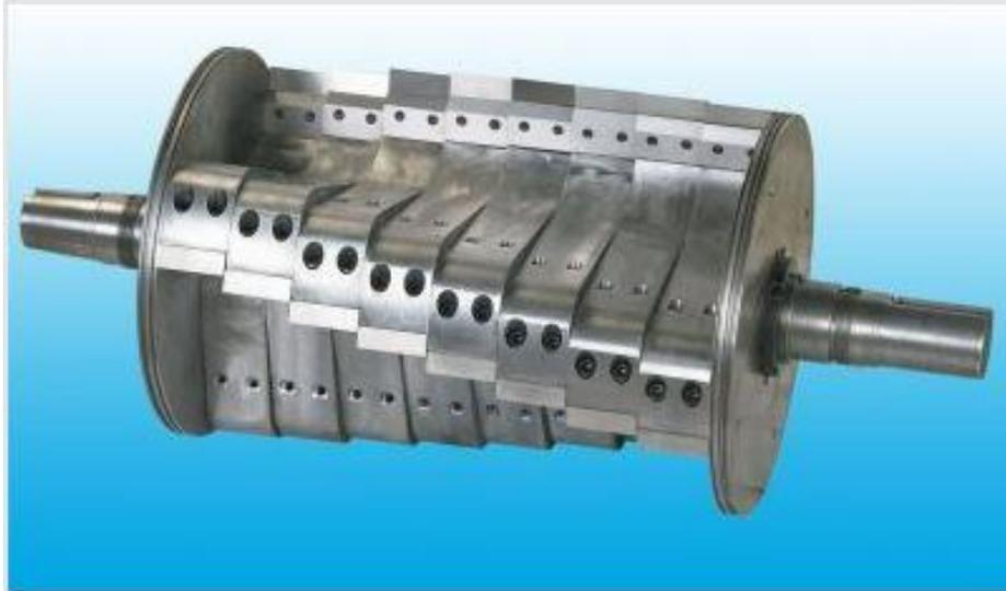
*Figura 9. Máquina trituradora de cuchillas o serie GR 2016
