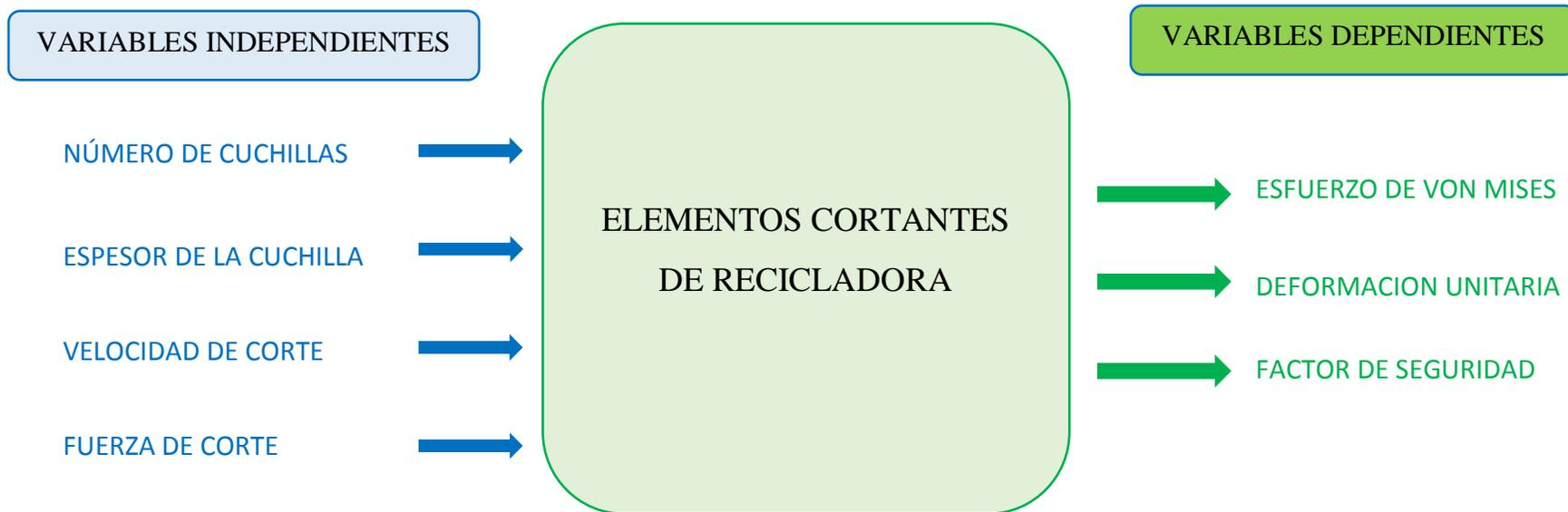
**Figura 24.** Caja negra para el diseño de elementos cortantes
