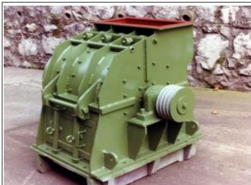
**Figura N° 9:** Molino de Martillos MMB.
