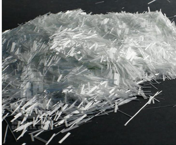
**Figura N° 2:** Fibra de vidrio Hilo cortado (fibra larga).
