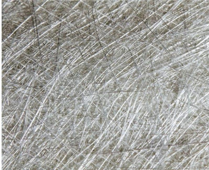
**Figura N° 5:** Fibra de vidrio – mat de hilos cortados.
