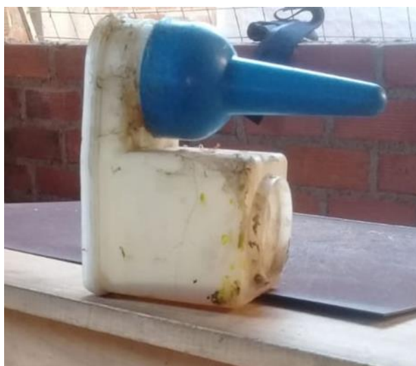
Figura 12. Contenedor adecuado para evitar el derrame del insumo y pérdidas de tiempo del operario
