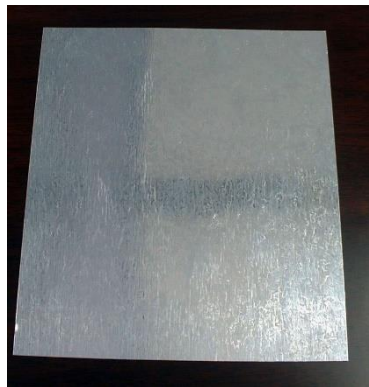
Ilustración 27 Lámina de acero galvanizado.
