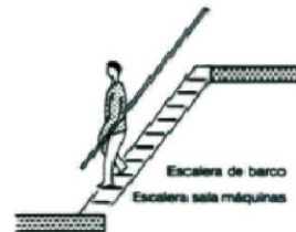
④ Escaleras a la molinera con barandilla
