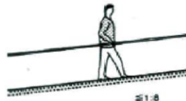
② Al aumentar la pendiente disminuye la longitud de los pasos. Pendientes cómodas: 1:10 - 1:8
