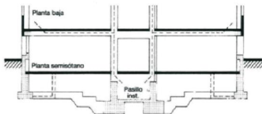
4 Sección transversal de un laboratorio con pasillo central
