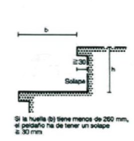
⑰ La relación entre huella y contrahuella no puede variar a lo largo de la línea de huella
