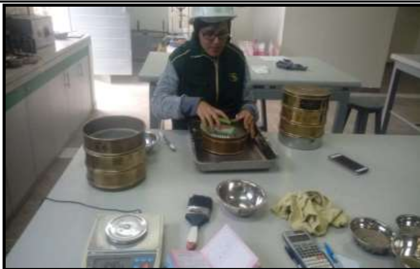
Figura 10. Separación de las partículas del terreno por los tamices.
