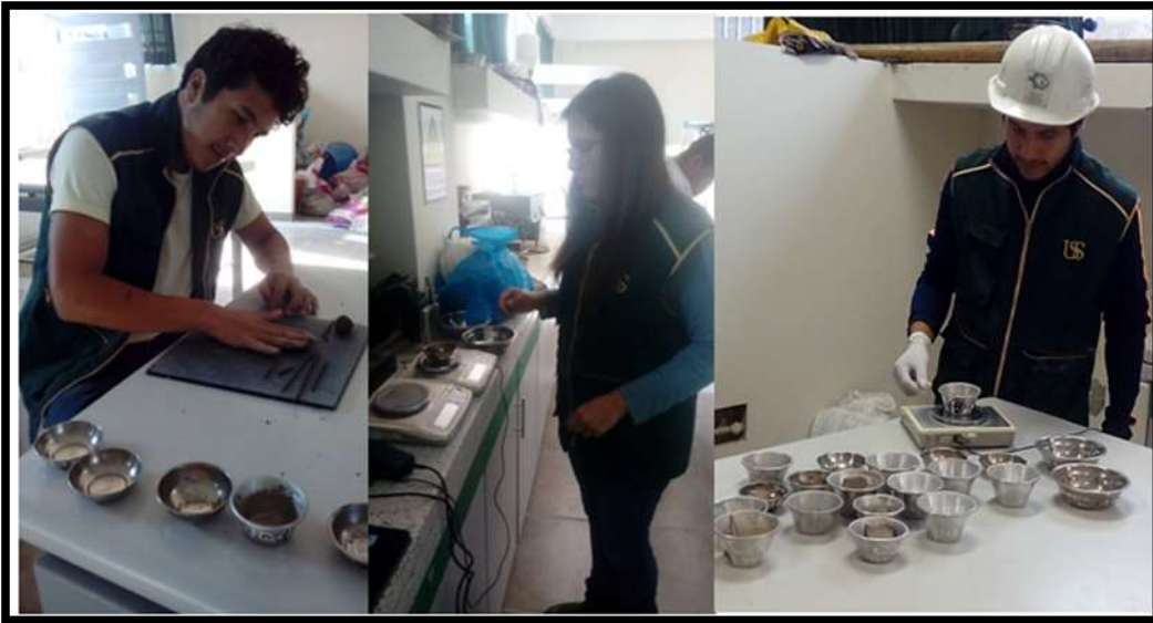
Figura 13. Ensayo del límite plástico en laboratorio.
