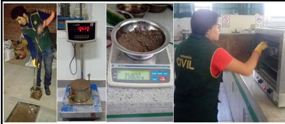
Figura 14. Ensayo de compactación en laboratorio.
