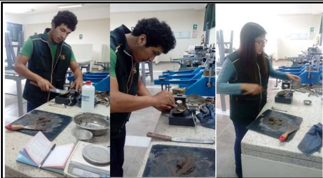
Figura 12. Ensayo de límite líquido en laboratorio
