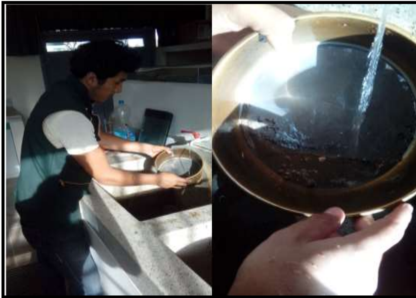
Figura 9. Separación de finos a través del lavado de muestra en la malla N°200
