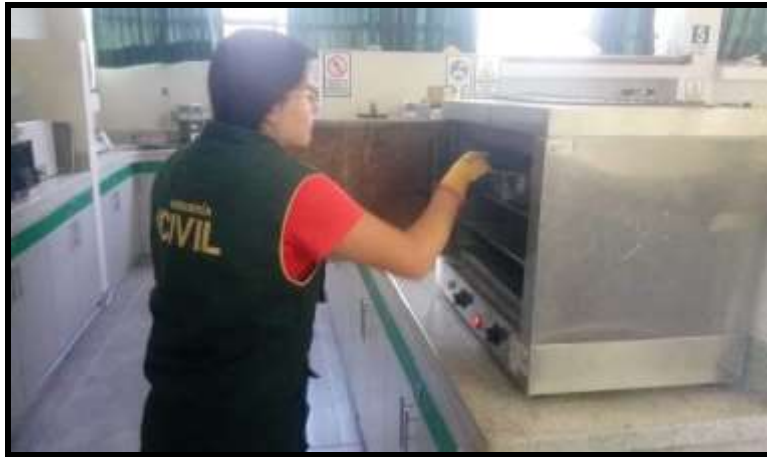
Figura 11. Secado del material en el horno para obtener el contenido de humedad.
