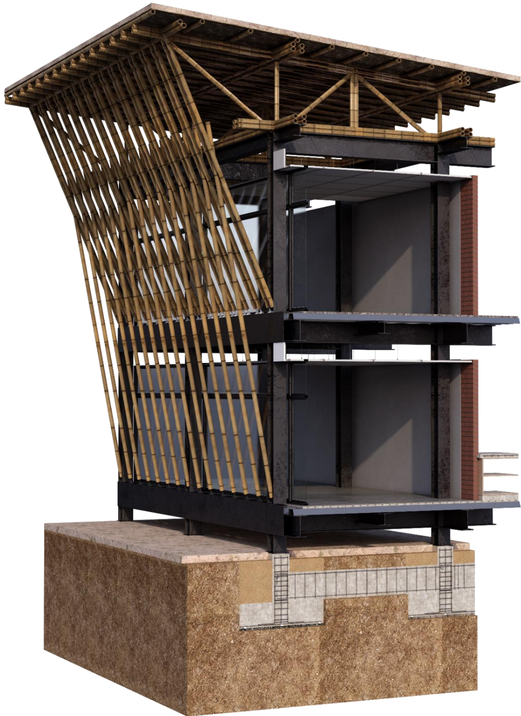
Figura 76. Imagen 3d - corte constructivo
