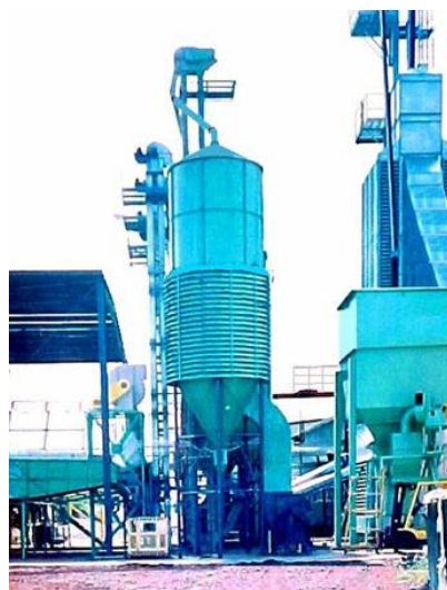
Figura 5. Secadora cilíndrica vertical Bendig. Fuente: Bendig, 2007
