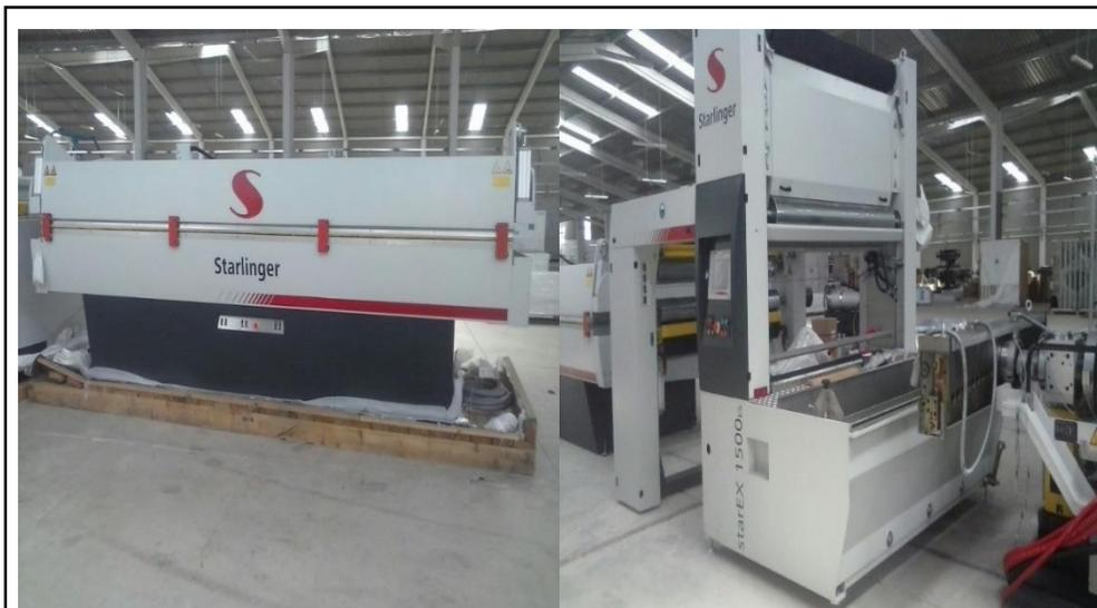
**Figura 12:** Maquina extrusora.
