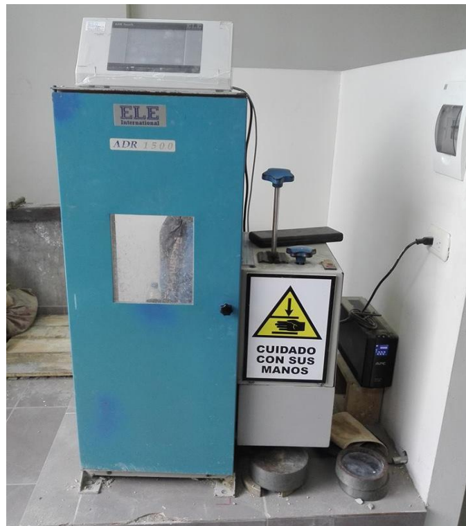
Figura 16 Prensa de Concreto para realizar los ensayos del concreto endurecido
