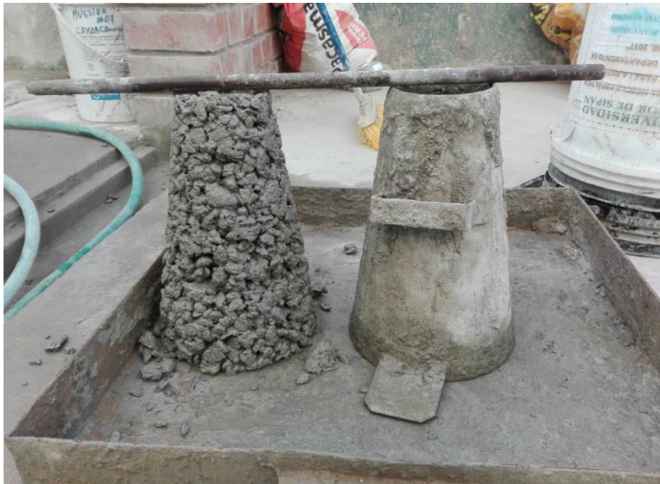
Figura 22. Comprobando el slump
