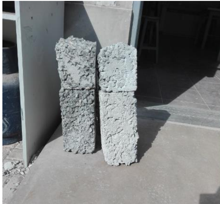
Figura 26. Rotura de las vigas a 1/3
