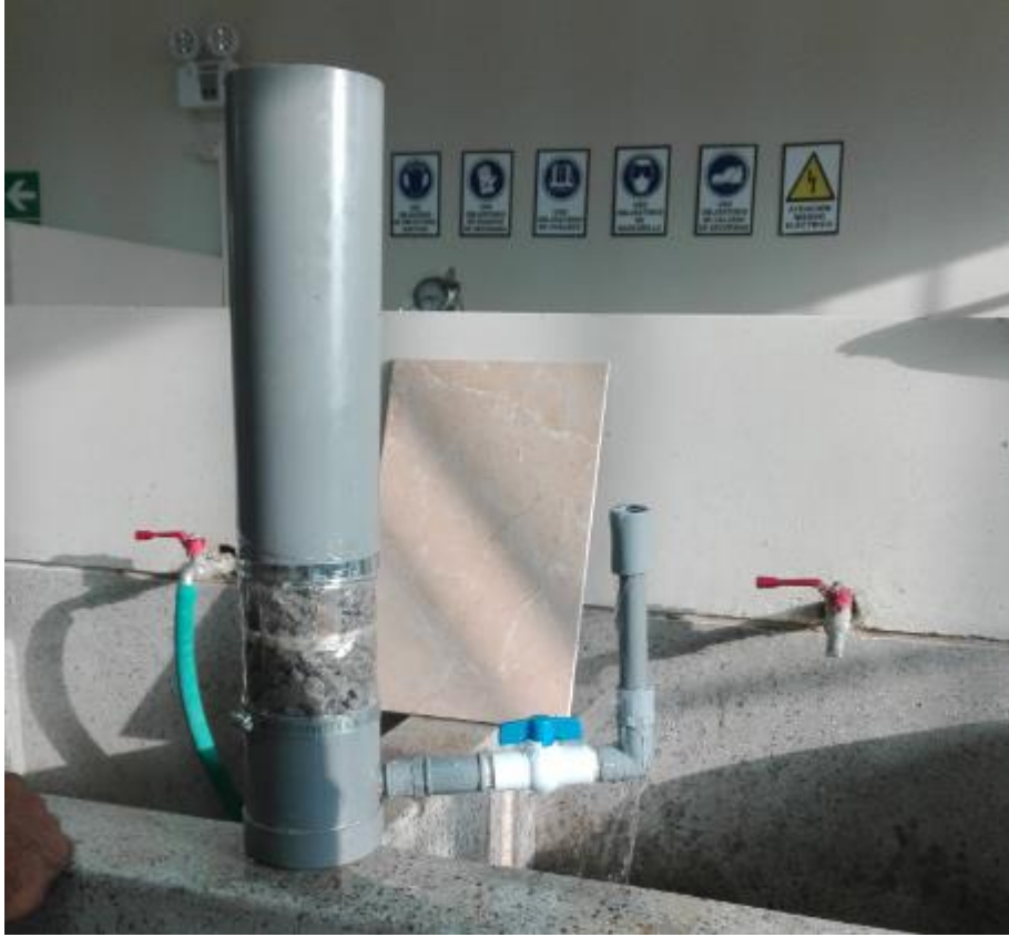
Figura 28. Ensayo de permeabilidad
