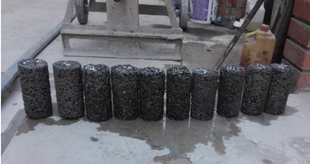
Figura 23. Especímenes del concreto permeable
