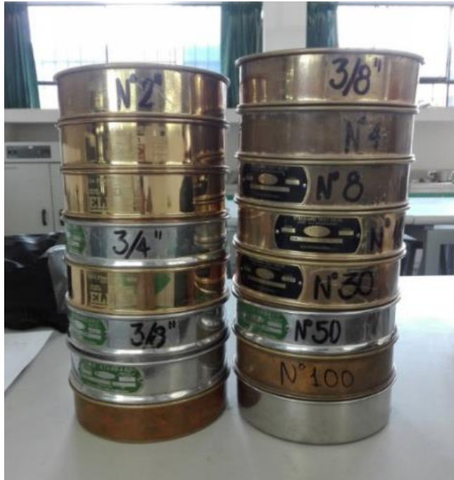
Figura 17. Tamices normalizados para el ensayo de granulometría
