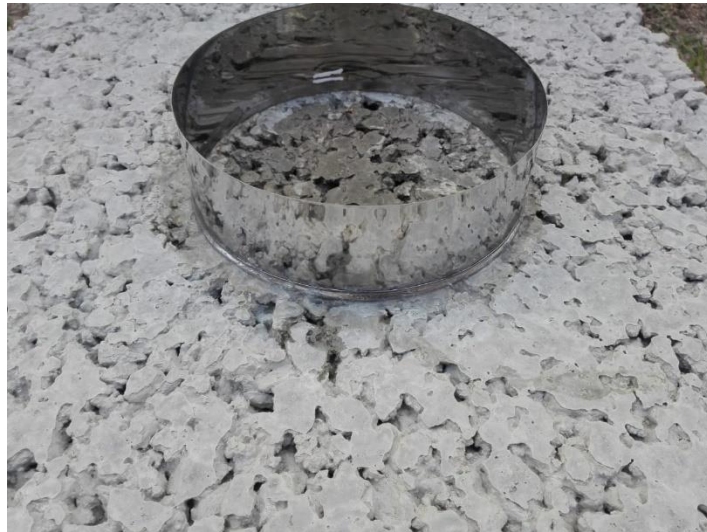
Figura 31. Ensayo de infiltración del concreto
