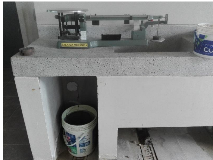
Figura 20. Realizando el ensayo peso específico y absorción de los materiales
