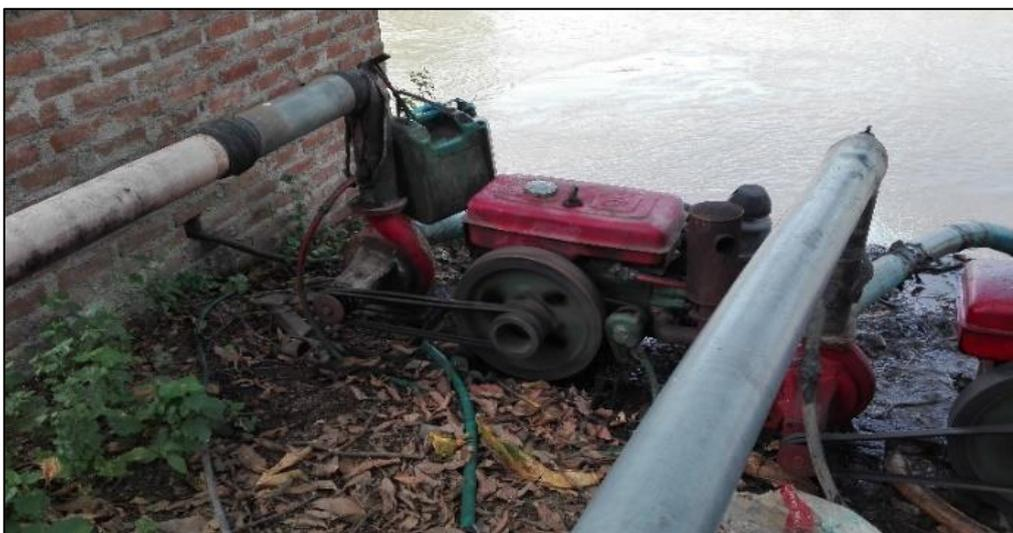
**Figura 2.** Motor petrolero que acciona la bomba para movilizar el agua del Canal Taymi para el riego de los cultivos de los agricultores de La Cria.
