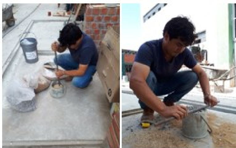
Figura. 2.18. Colocaci3n, apisonado y enrasado de los materiales en el molde cilindrico Fuente: Elaboraci3n propia
