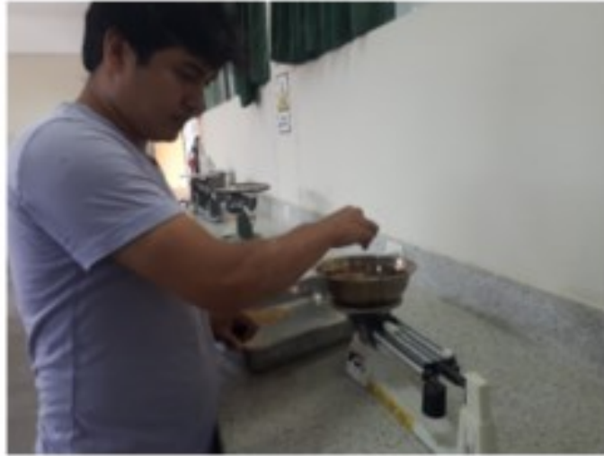
Figura. 2.23. Selección y pesado de muestra (arena). Fuente: Elaboración propia
