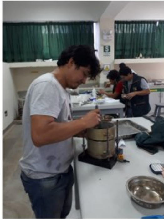
Figura.2.33 Colocación y apisonado (compactación con pisón) del confitillo dentro del molde cilíndrico
