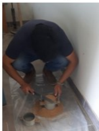
Figura 2.30. Enrasado de la muestra (arena) dentro del molde cilíndrico, para determinar su peso. Fuente: Elaboración propia
