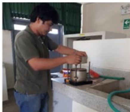
Figura 2.32 Enrasado de la muestra (arena) dentro del molde cilíndrico Fuente: Elaboración propia
