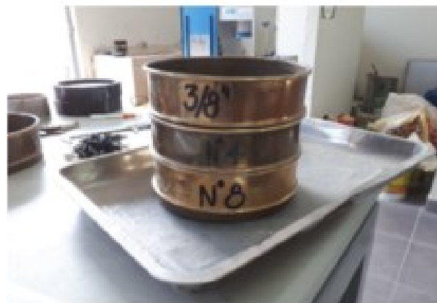
Figura. 2.11 Grupo de tamices empleados en la selección del confitillo. Fuente: Elaboración propia
