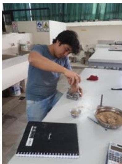
Figura. 2.36. Compactación y colocación de la arena dentro del molde de sección circular Fuente: Elaboración propia
