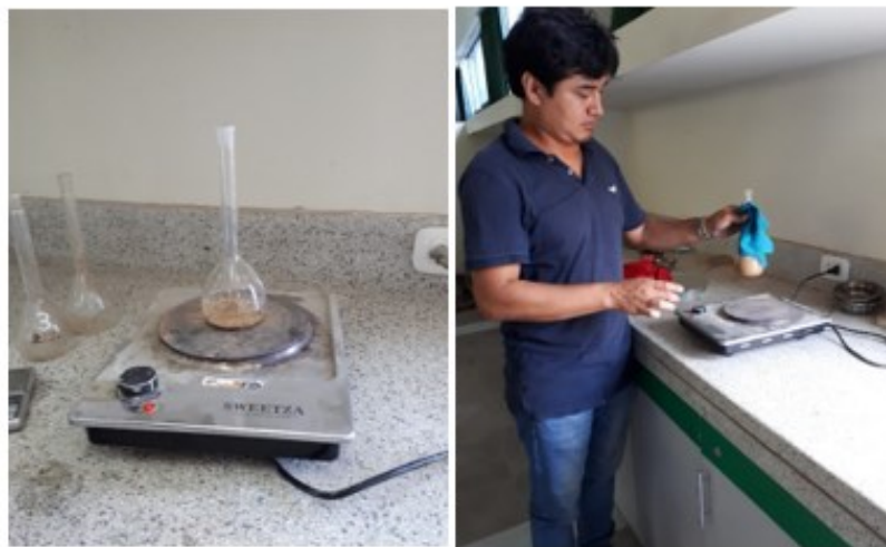
Figura. 2.16. Liberación del aire atrapado en la muestra de arena.
