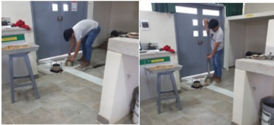
Figura.2.31 Colocación y apisonado de la muestra (arena) dentro del molde cilíndrico Fuente: Elaboración propia
