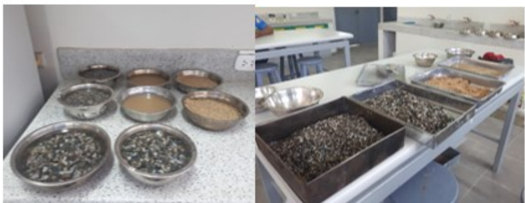
Figura. 2.20 Selección y saturación de muestra (arena/confitillo)
