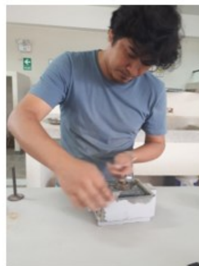
Figura. 2.36. Compactación y colocación de la arena dentro del molde de sección circular Fuente: Elaboración propia
