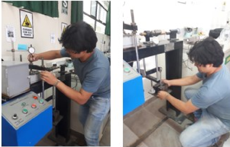
Figura. 2.37. Colocación del molde en el equipo de corte (previa preconsolidación de muestra) Fuente: Elaboración propia
