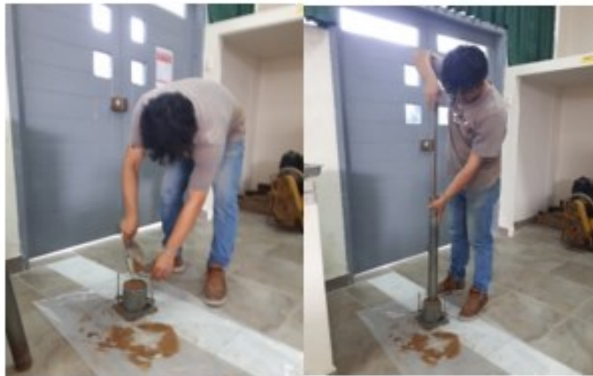
Figura 2.29. Apisonado de la muestra (arena) dentro del molde cilíndrico, para determinar su peso.
