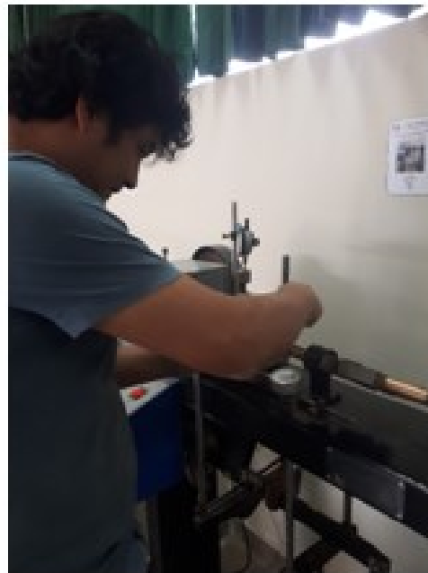
Figura. 2.38. Lecturas en los Diales cada cierto tiempo (para una determinada carga aplicada) Fuente: Elaboración propia
