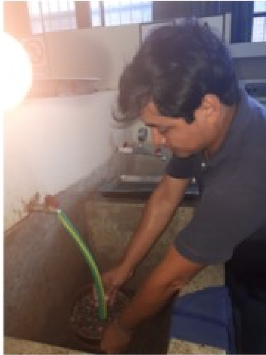
Figura. 2.12 lavado de confitillo Fuente: Elaboración propia
