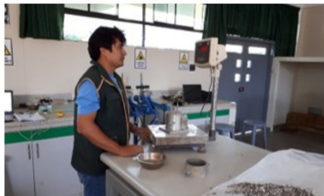
Figura. 2.28 Peso de las muestras con los agregados dentro de molde cilindro Fuente: Elaboración propia
