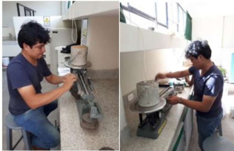
Figura 2.19 Peso de las muestras sin y con apisonamiento de los agregados. Fuente: Elaboración propia
