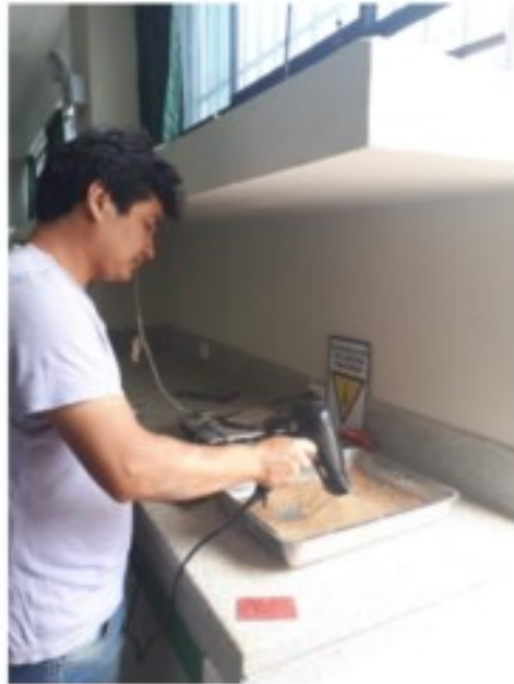
Figura. 2.21. Oreado de la muestra de arena con el uso de una secadora Fuente: Elaboración propia
