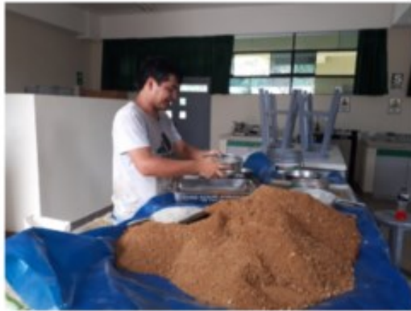
Figura.2.8. Tamizado de la arena gruesa a través de la malla N° 40. Fuente: Elaboración propia
