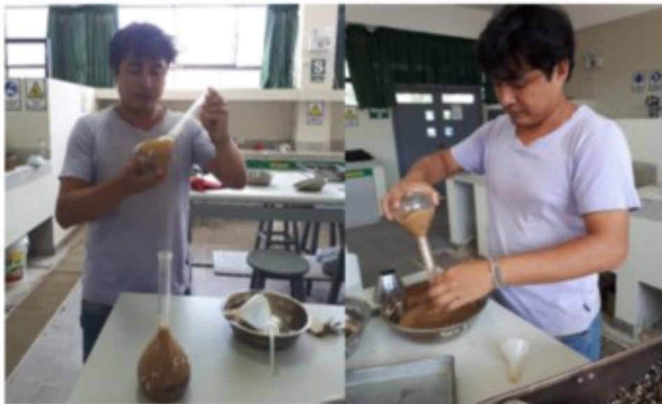
Figura. 2.24. Agitación leve de muestra y selección de esta para la colocación en horno. Fuente: Elaboración propia
