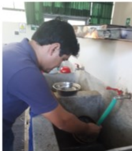
Figura. 2.9 Arena sometida a lavados sucesivos a través de la malla N° 40. Fuente: Elaboración propia
