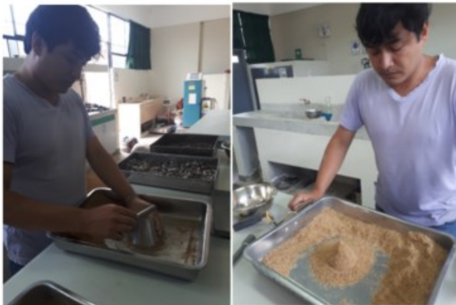
Figura. 2.22. Apisonado de la muestra dentro del molde cónico. Fuente: Elaboración propia
