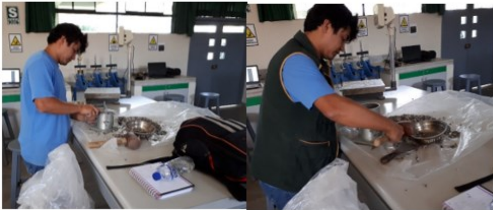
Figura. 2.27. Colocación y vibrado de la muestra (confitillo) dentro del molde. Fuente: Elaboración propia
