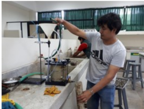
Figura. 2.35. Toma de mediciones en el permeámetro de carga constante Fuente: Elaboración propia
