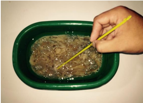
Figura 17. Precipitado con alcohol y agitación
