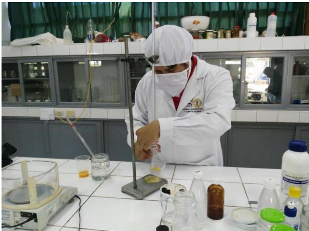
Figura 27. Determinación de la Acidez titulable
