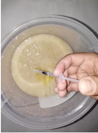
Figura 20. Adición de Polisorbato 80 y Glicerol al mucilago hidratado
