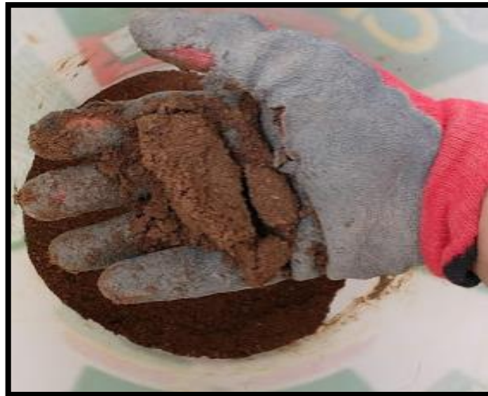
Imagen 27 consistencia de la mezcla usada en la elaboración del ladrillo ecológico, fuente elaboración propia.
