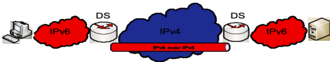
Fig. 6 Topología del Mecanismo Tunelización [31]
