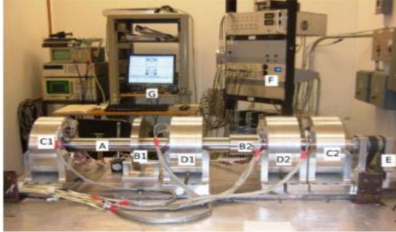
Figura 16 Equipo de prueba para Rotor Flexible con cojinete magnético activo. Fuente: Simón, et al.2011)
