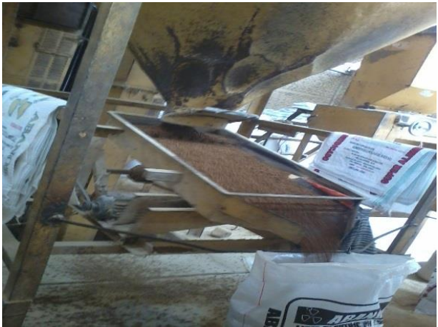
Figura 44: Llenado de sacos Fuente: Elaboración propia.
