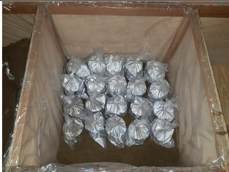
Figura 80. Probetas suelo cemento, en bolsa para su curado en tierra húmeda.
