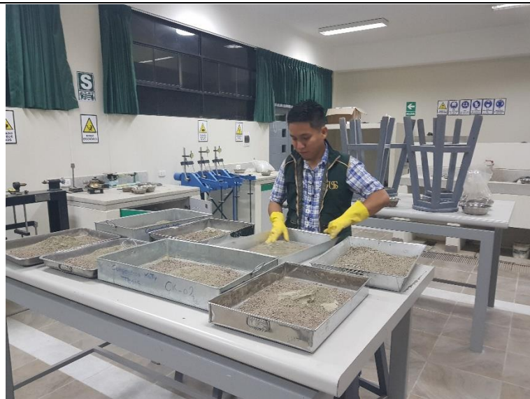
Figura 5. Mezcla de suelo cemento y agua
