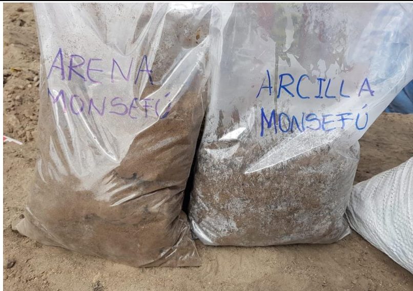
Figura 73. Muestra inalterada, para obtener su contenido de humedad
