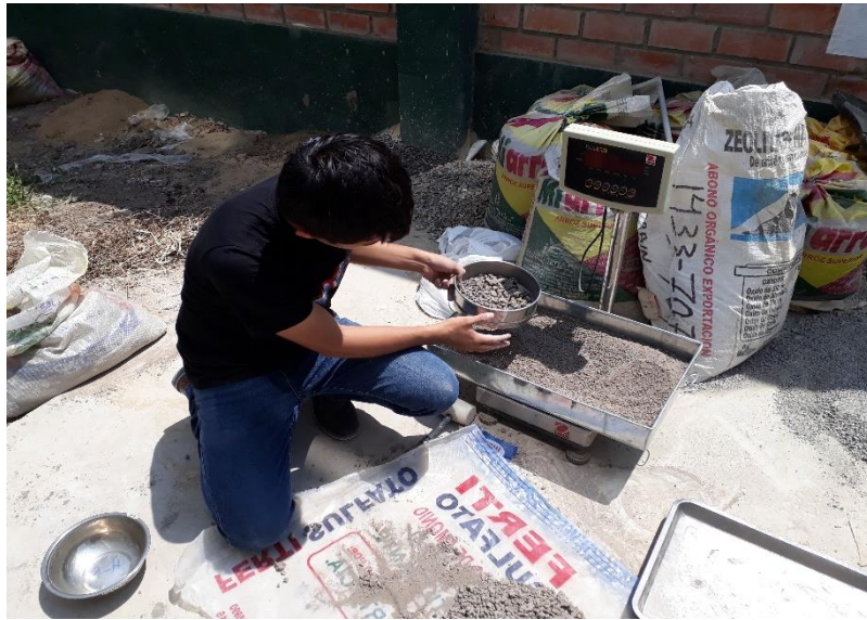
Figura 77. Peso de muestra para estabilizar suelo.
