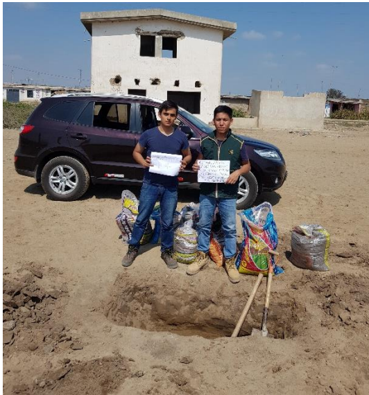
Figura 71. Extracción de muestra. Calicata Ferreñafe 1
