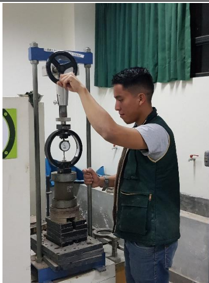
Figura 9. Ejecución del ensayo para determinar la resistencia suelo cemento
