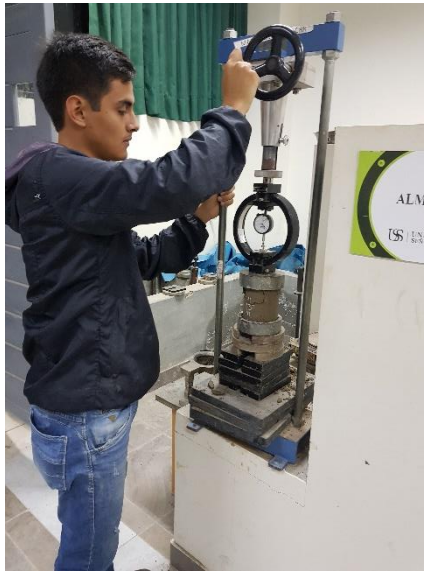
Figura 82. Ejecución de ensayo a la resistencia suelo cemento
