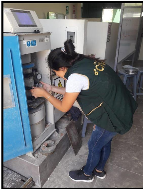
*Figura 65 Ensayo módulo de elasticidad ASTM C-469*
