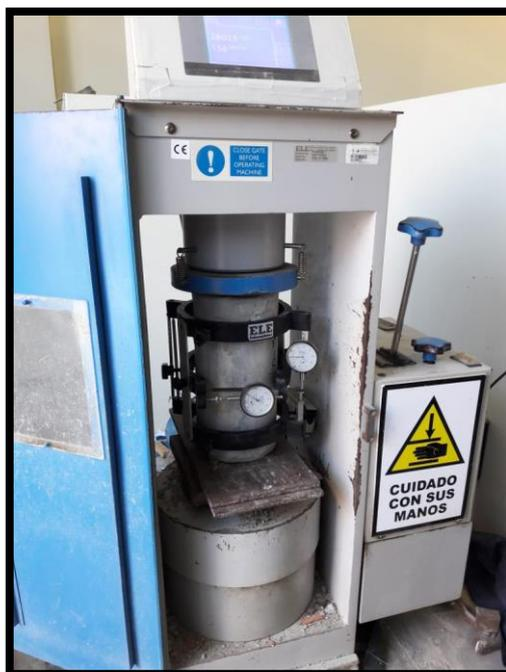
*Figura 59 Ensayo de módulo de elasticidad ASTM C-469*
