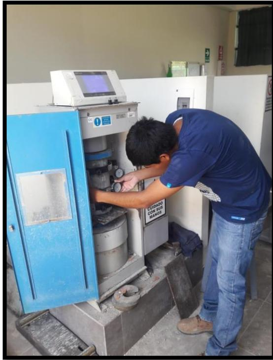
*Figura 66* Ensayo módulo de elasticidad ASTM C-469
