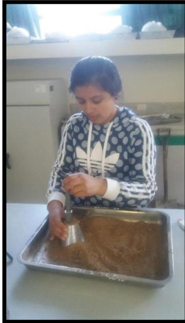
*Figura 51 Muestra del agregado fino saturada superficialmente seca*
