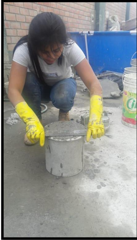
*Figura 55* Peso unitario del concreto fresco. NTP 400.017
