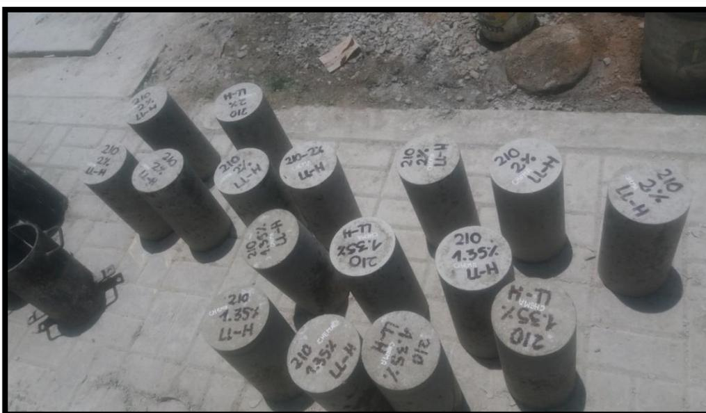
*Figura 63 Desencofrado de probetas*
