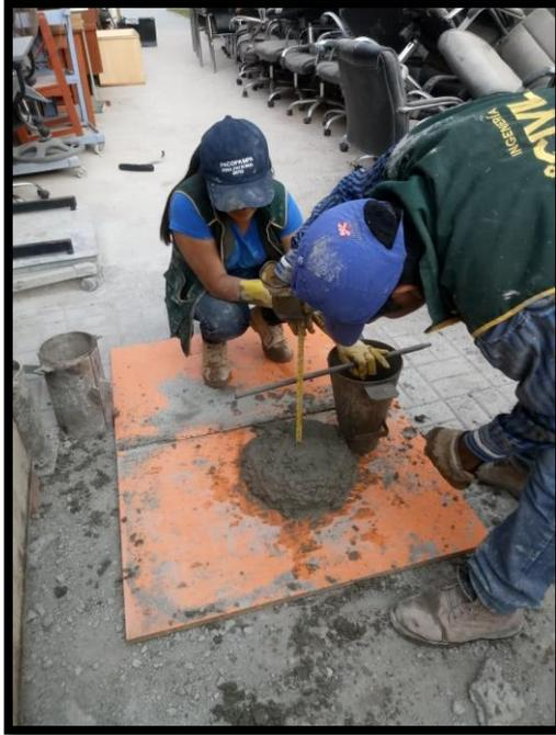
*Figura 53 Verificación del asentamiento del concreto. NTP 339.035*
