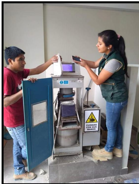
*Figura 57 Resistencia a la flexión. NTP 339.078*
