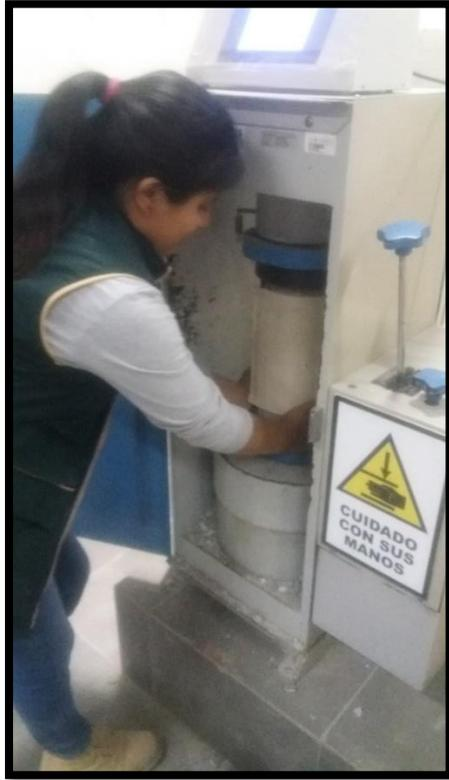
*Figura 56 Resistencia a la compresión. NTP 339.034*
