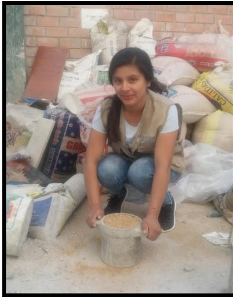
*Figura 49* Peso Unitario Compactado del Agregado Fino. NTP 400.017
