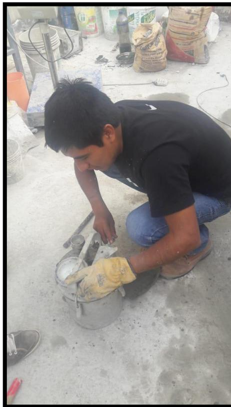
*Figura 54 Contenido de aire atrapado en el concreto. NTP 334.089*
