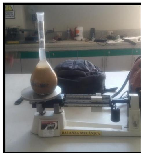
*Figura 52 Peso específico del agregado fino. NTP 400.022*
