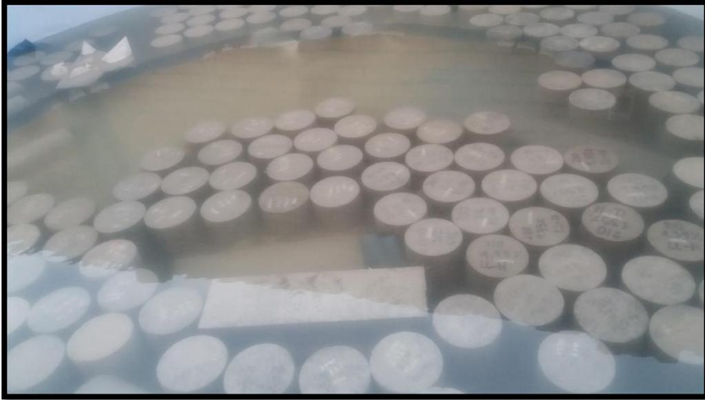
*Figura 64 Curado de probetas*
