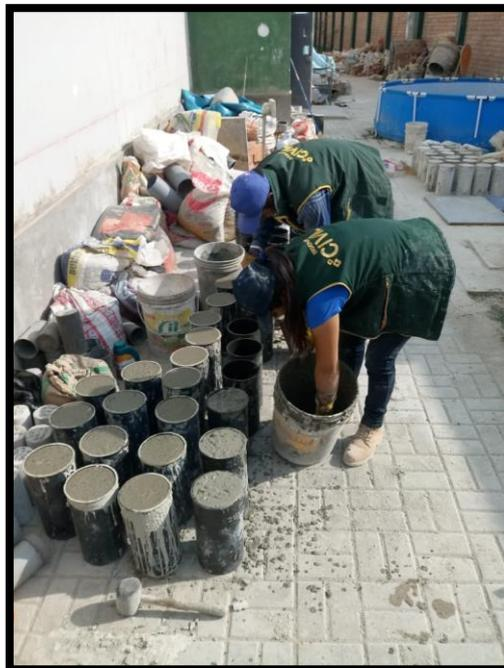
*Figura 61 Vaciado de probetas*
