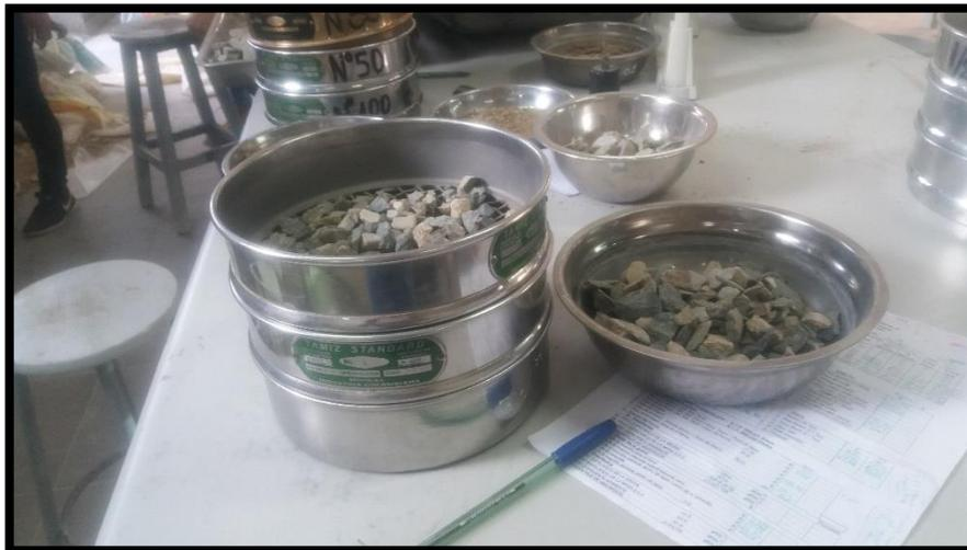
*Figura 48 Análisis granulométrico de los agregados. Norma N.T.P. 400.012 (Agregado. Fino) y Norma N.T.P. 400.012 (Agregado. Grueso)*
