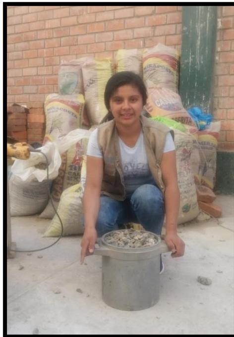
*Figura 50* Peso Unitario Compactado del Agregado Grueso. NTP 400.017
