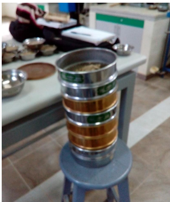
Fotografía N° 13: Tamices para el ensayo de granulometría
