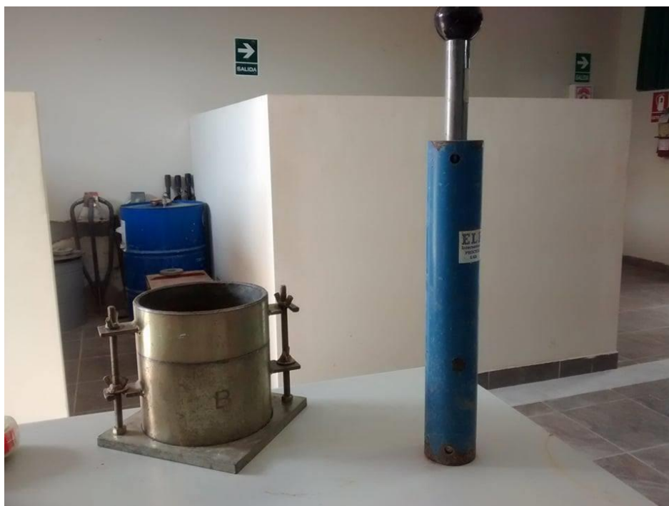
Fotografía N° 12: Materiales para el Ensayo de Proctor
