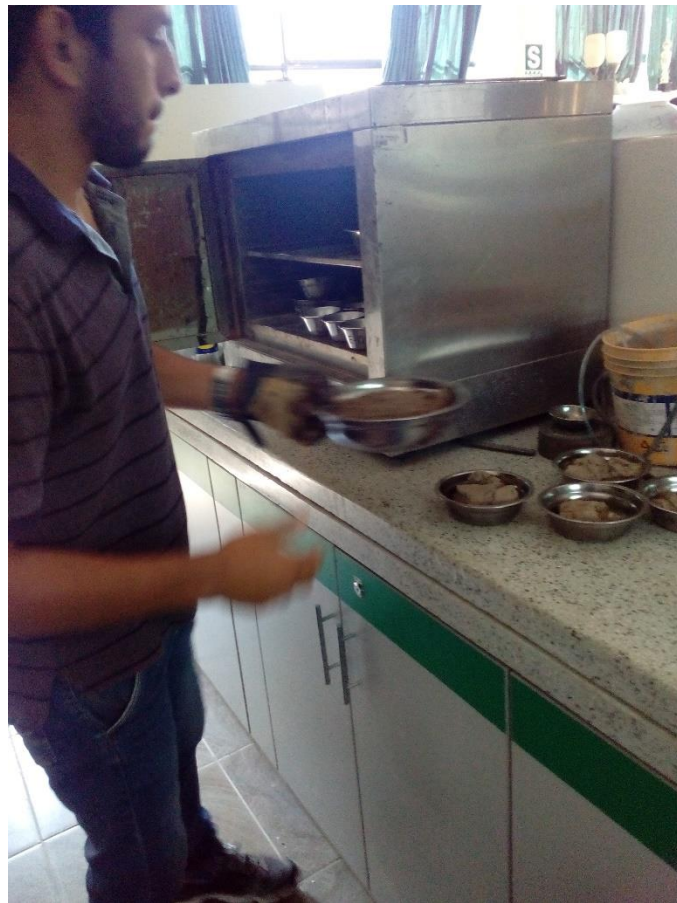
Fotografía N° 04: Muestras al horno para hallar contenido de humedad
