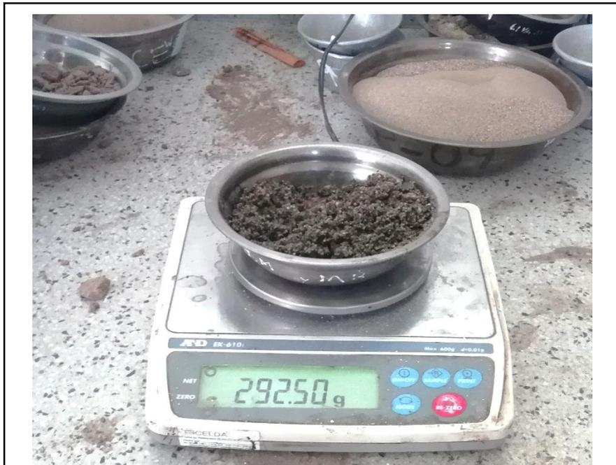
**Figura 7:** Peso de la muestra 7 seca al horno de la calicata 5
