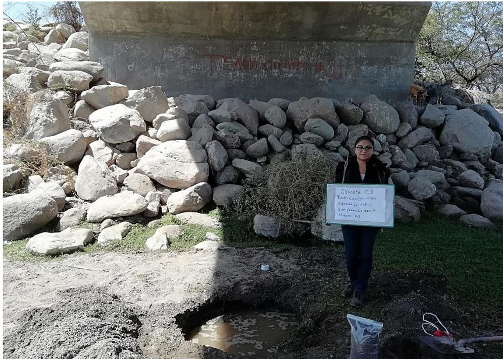
**Figura 14:** Calicata 2, extracción de muestra 2
