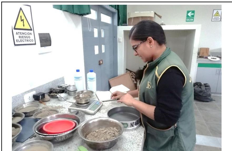
**Figura 44:** Peso húmedo con todo tara, de la muestra 7 - calicata 5
