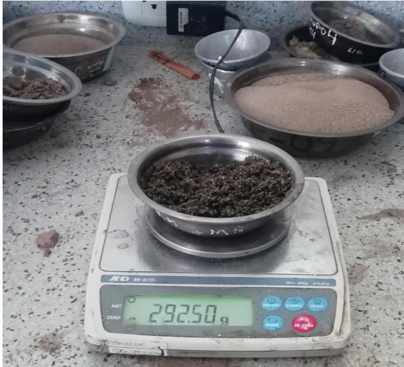
**Figura 18:** Peso húmedo con todo tara, de la muestra 7 - calicata 5
