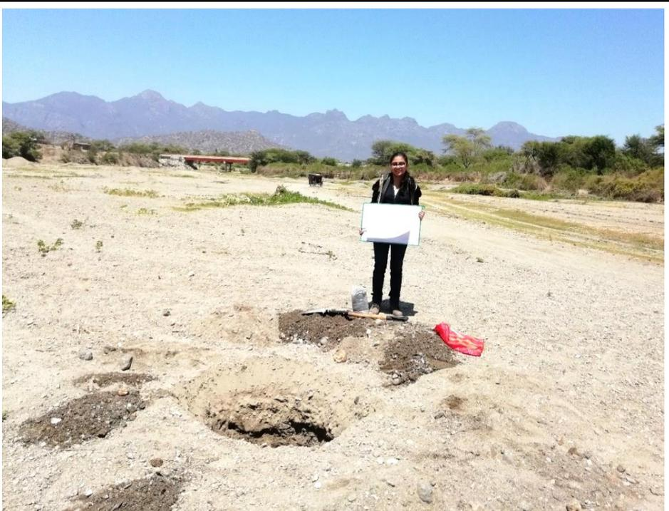
**Figura 43:** Calicata 5 , extracción de 1 muestra
