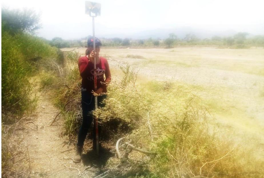
**Figura 2:** Borde de terreno natural margen derecha del rio, jalón con prisma
