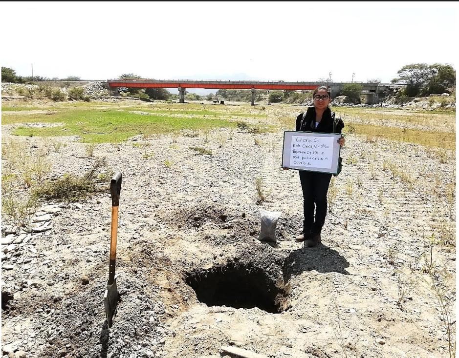
**Figura 42:** calicata 4, extracción de 1 muestra
