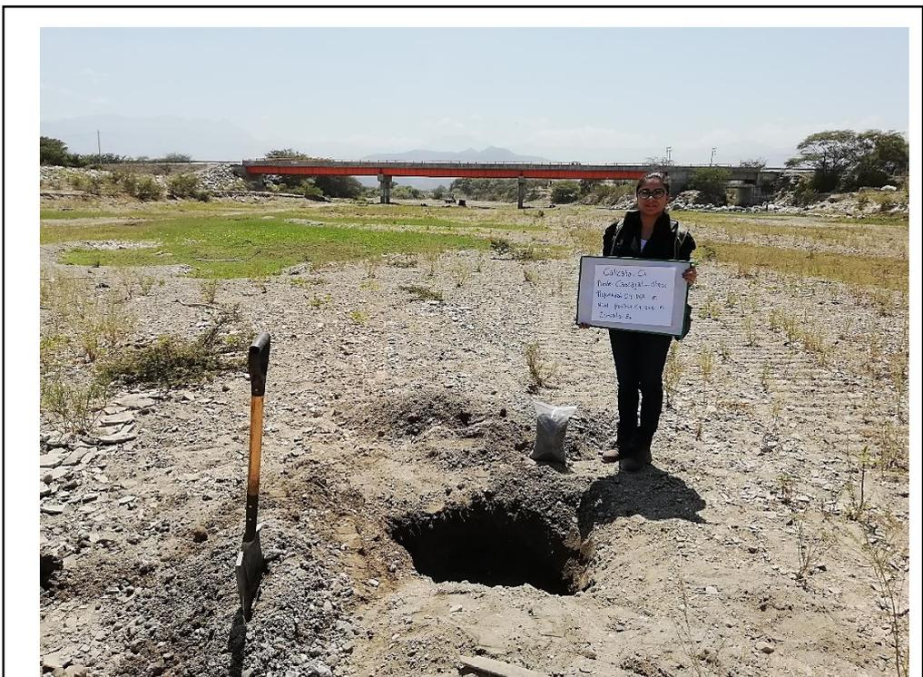
**Figura 16:** calicata 4, extracción de 1 muestra
