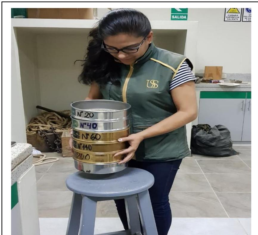
**Figura 20:** Tamizado de las muestras obtenidas en el río Cascajal
