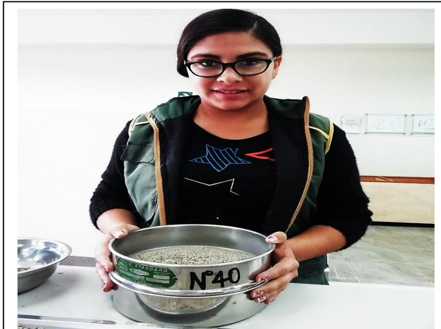
**Figura 1046:** Tamizado de la muestra para hacer el ensayo de
