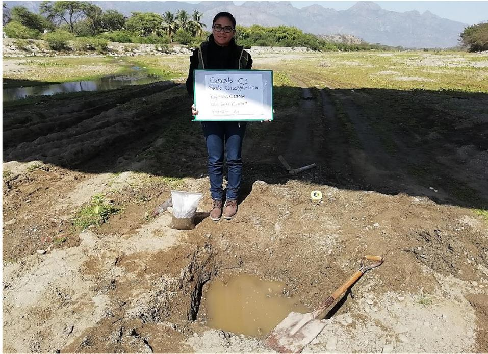
**Figura 13:** Calicata 1, extracción de muestra 1
