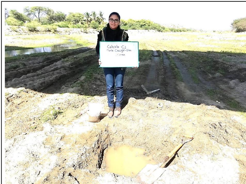
**Figura 2:** Calicata 1, extracción de muestra 1
