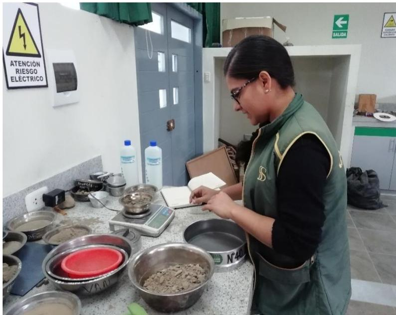
**Figura 19:** Peso de la muestra 7 seca al horno de la calicata 5
