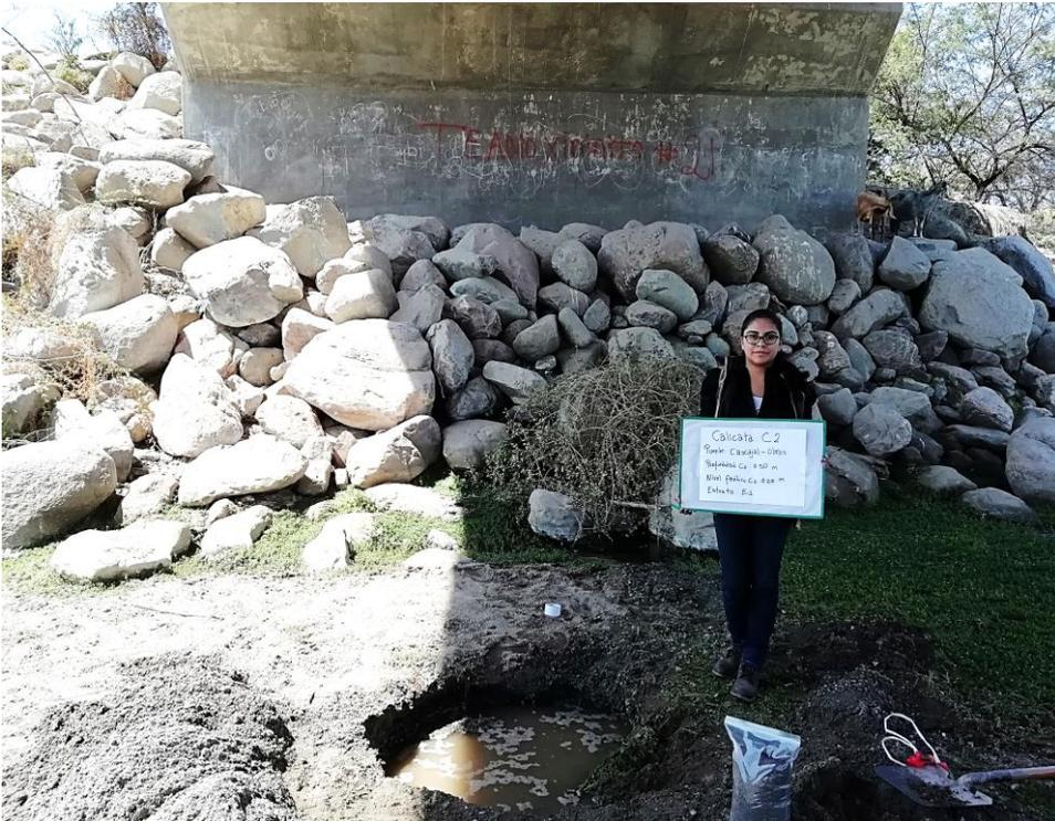
*Figura 10: Calicata 2, extracción de muestra 2*
