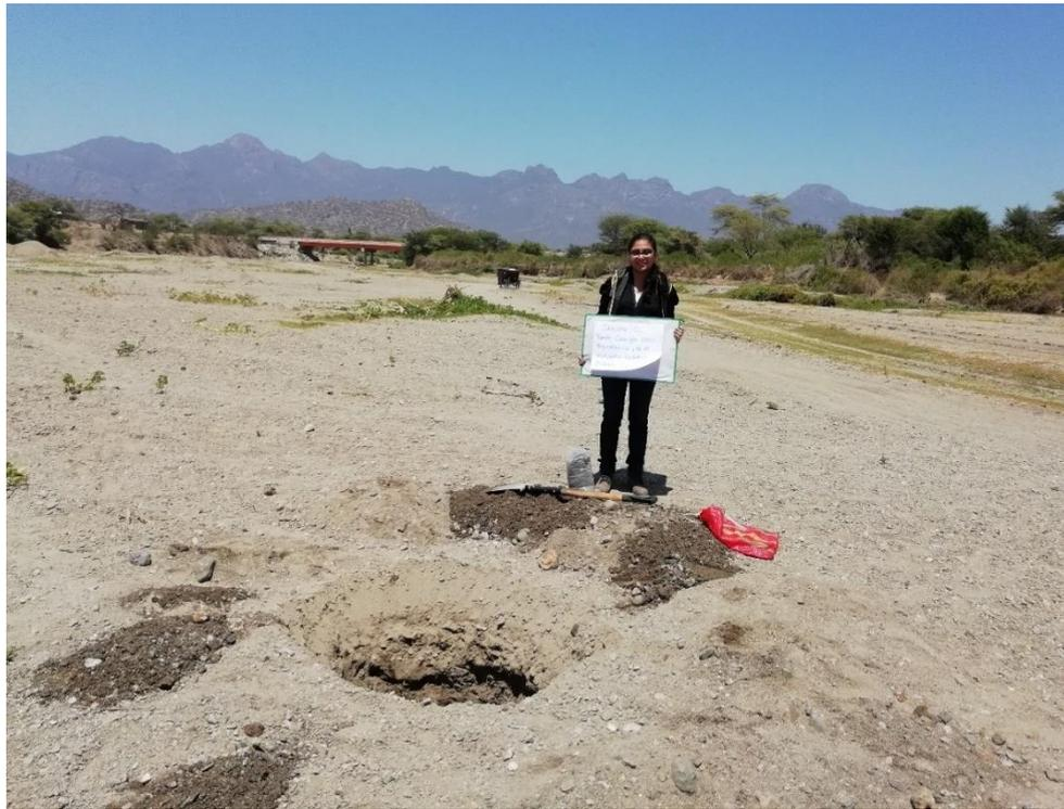
**Figura 17:** Calicata 5 , extracción de 1 muestra
