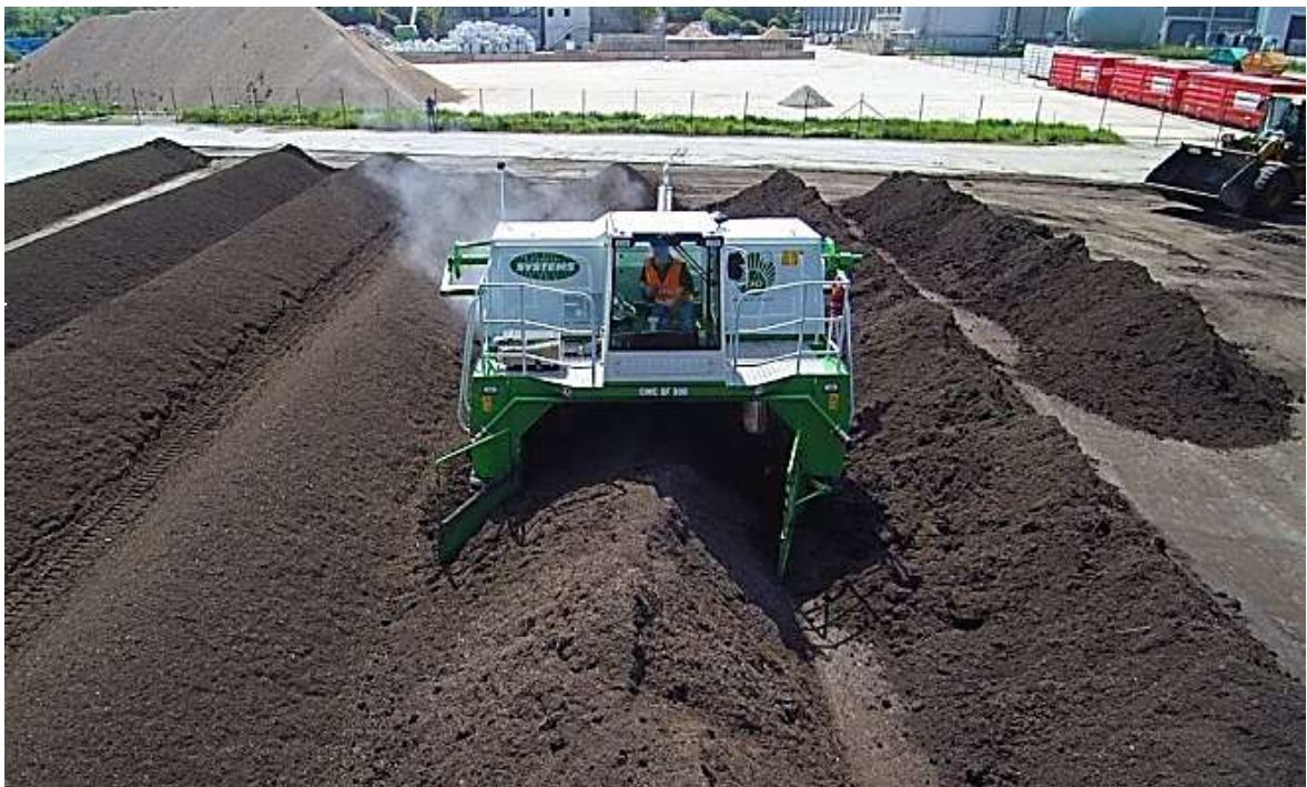
Figura 8: Maquina volteadora de compost Fuente: Compost System
