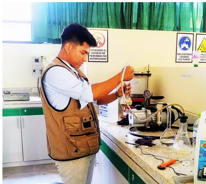
Ilustración 41. Extrayendo el aire atrapado.
