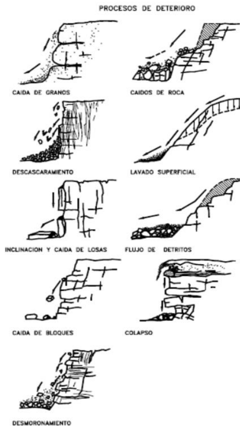
Ilustración 4. Procesos de deterioro en macizos rocosos (Nicholson y Hencher –1997)
