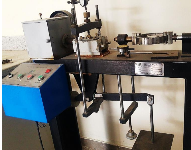
Ilustración 46. Equipo de Corte Directo
