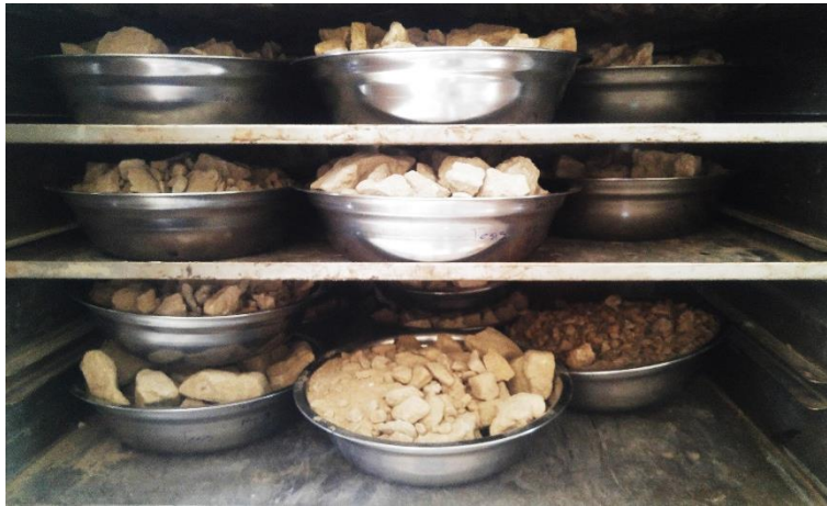
Ilustración 22. Muestras en el horno a 110°C +/-
