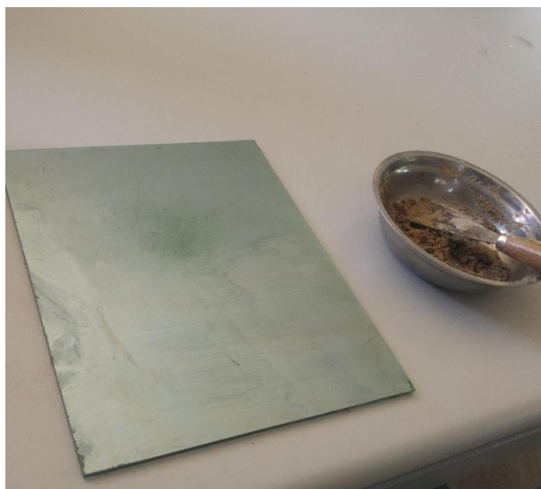
Ilustración 32. muestra con plasticidad nula.
