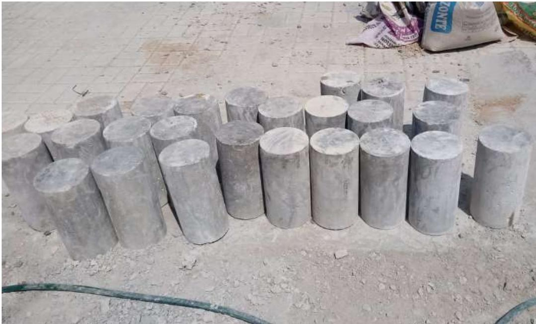
d) Curado de las muestras, para luego proceder con los ensayos
