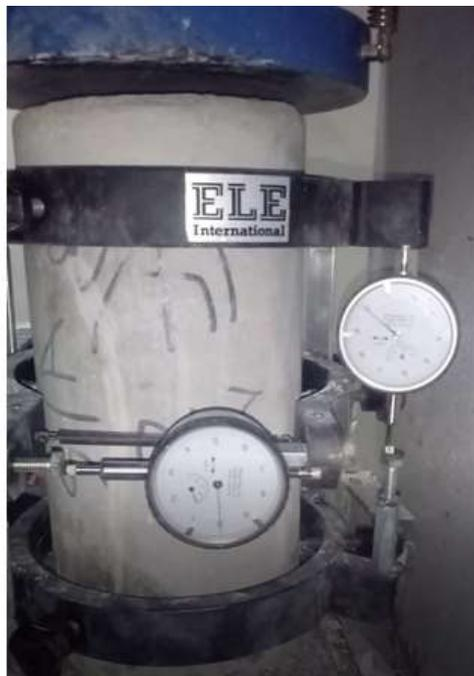
p) Falla que presenta la muestra tras ser sometida al ensayo de módulo de elasticidad
