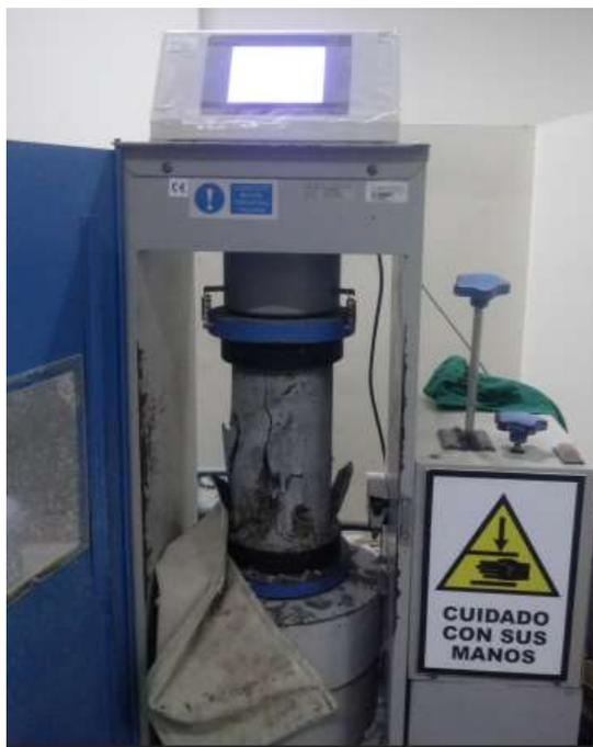
c) Muestra de concreto adherida que falla tipo 3 - Compresión
