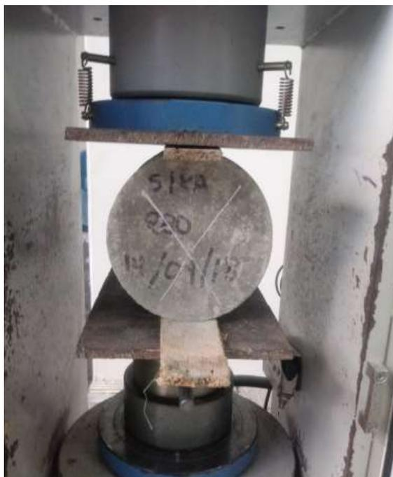
g) Muestra de concreto adherida que falla tipo 3- tracción
