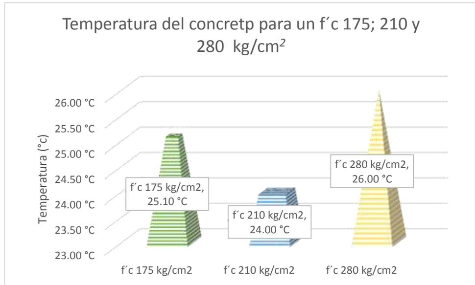
**Gráfico 4:** Comparación de Temperatura para un f'c 175, 210 y 280 kg/cm<sup>2</sup>.
