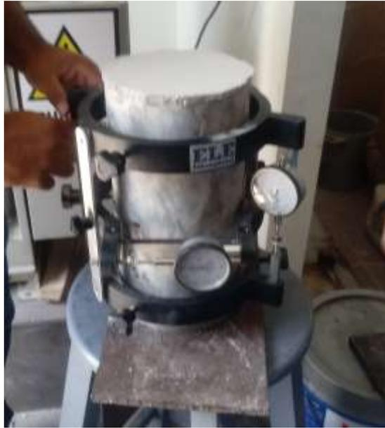
o) Muestras de concreto, más la máquina del módulo de elasticidad dentro de la máquina de compresión
