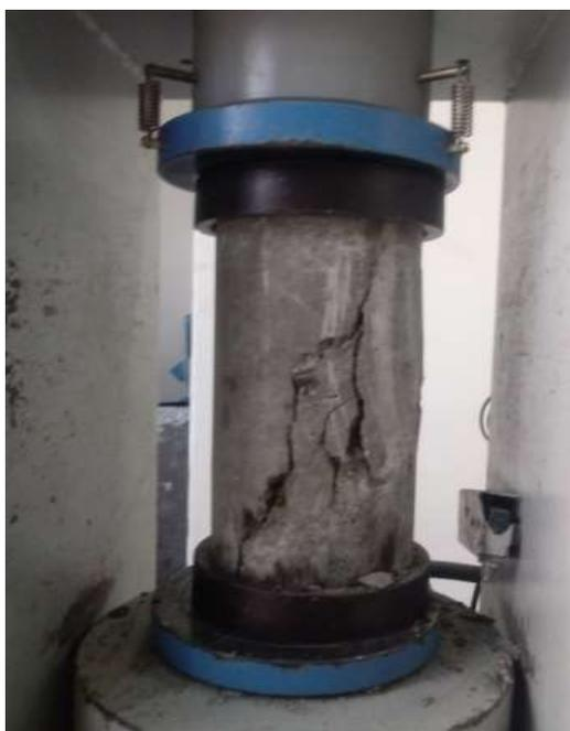
d) Muestra de concreto adherida que falla tipo 3 - Compresión
