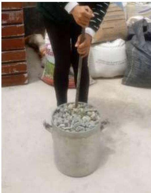
b) Llenado de molde con agregado grueso, varillado
