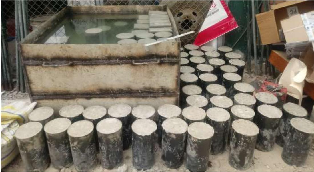
c) Desencofrado de los Espécimenes –Concreto Patrón
