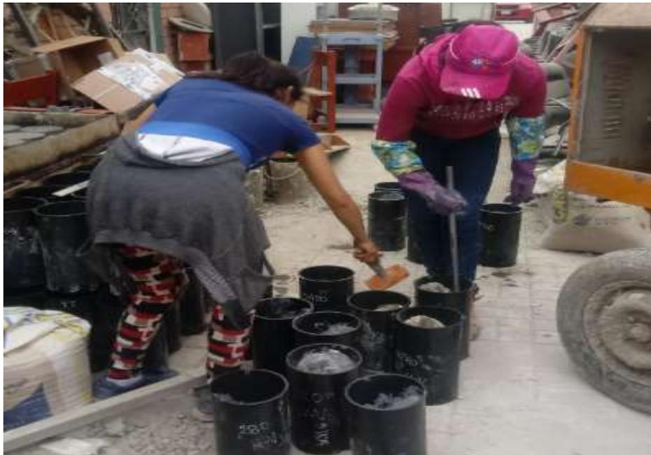
b) Muestras de concreto unidas con aditivos epóxicos,
