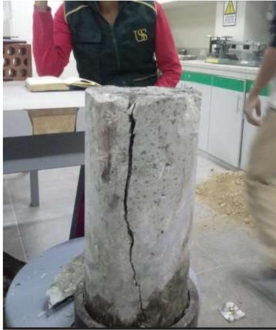
e) Muestra de concreto adherida a ser ensayada por tracción
