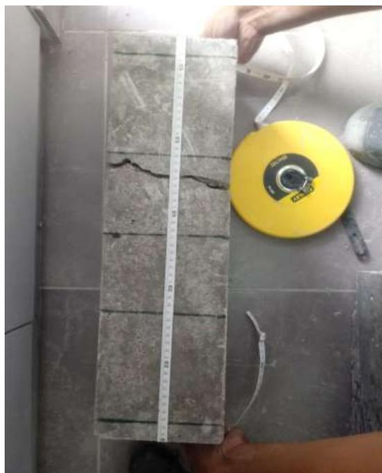
l) Se debe obtener el ancho de la viga
