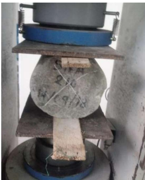
h) Muestra de concreto adherida que falla tipo 3- tracción
