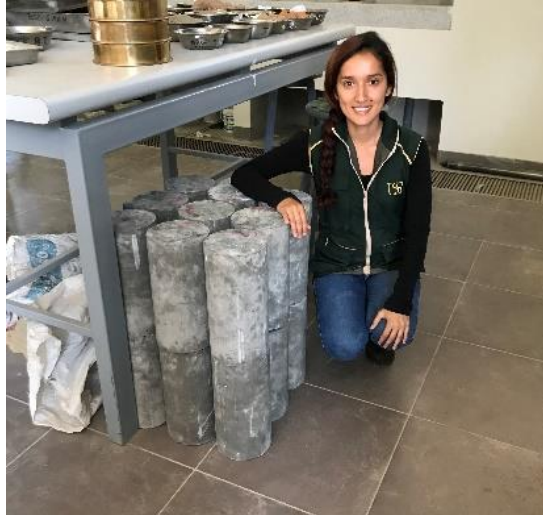
Figura 15. Probetas seleccionadas para el ensayo de resistencia a la compresión.
