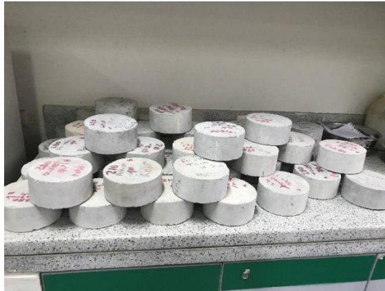
Figura 24. Probetas cortadas con un diámetro de 75 mm para el ensayo de absorción capilar.
