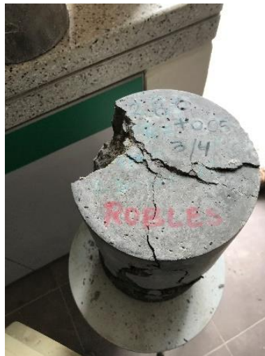
Figura 16. Probeta después de haber sido sometida a carga perpendicular a su superficie.
