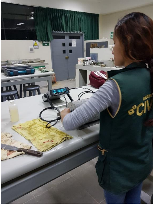
Aplicación del ensayo pulso ultrasónico.
