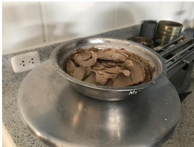
Figura 9. Agregado fino pesado después de mantenerlo en el horno.
