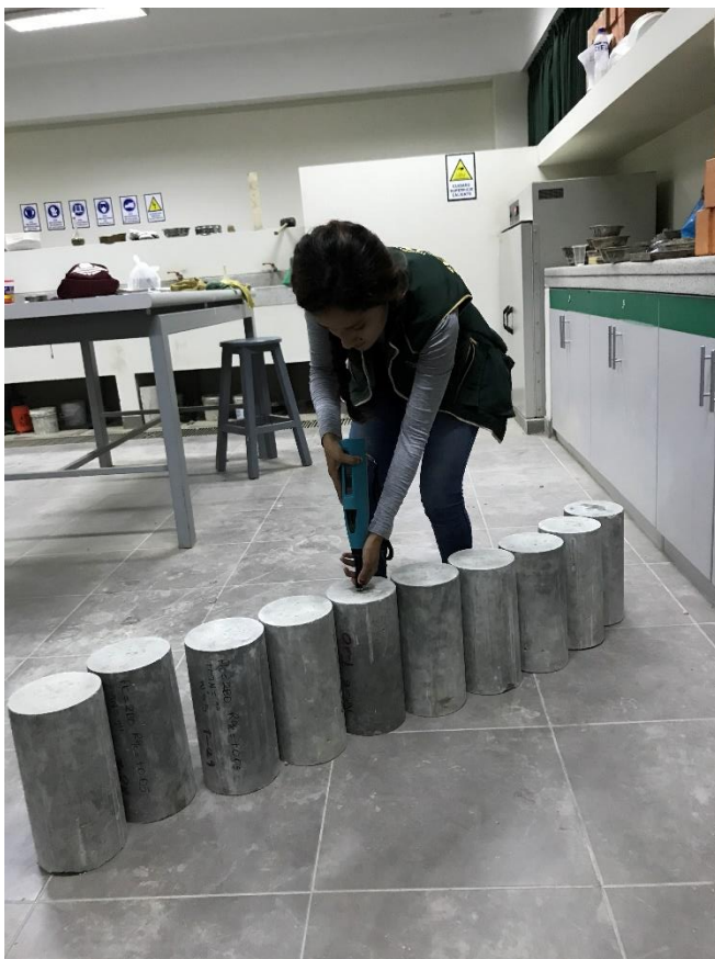
Probetas utilizadas para el ensayo de numero de rebote.
