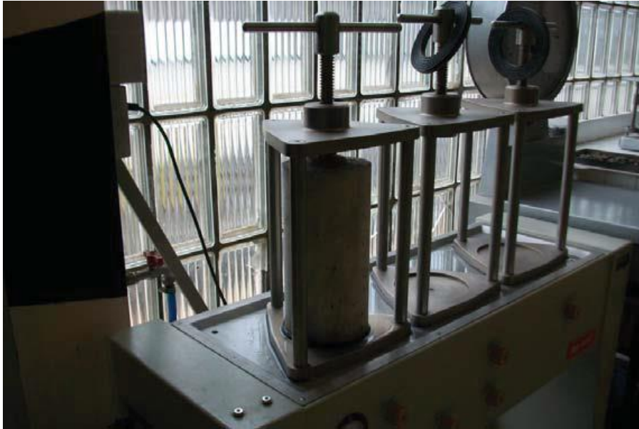
Figura 23. Equipo para realizar el ensayo de profundidad de penetración de agua bajo presión.
