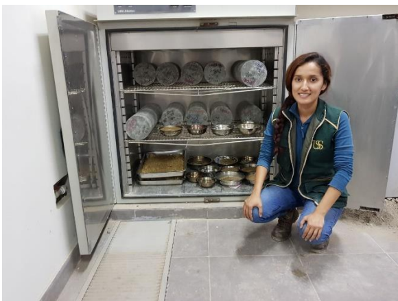
Muestras puestas en horno para la determinación de densidad y contenido de vacíos.
