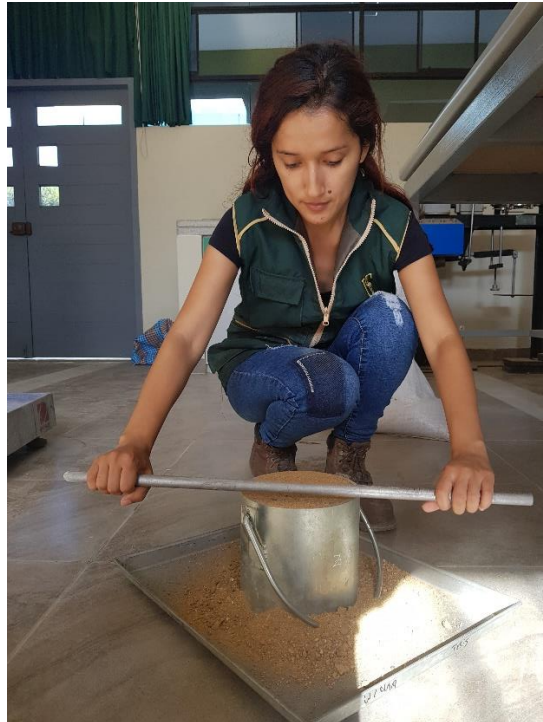
Figura 6. Agregado fino siendo colocado en balde metálico.
