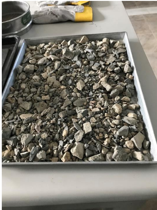
Figura 11. Agregado grueso puesto en bandeja metálica.
