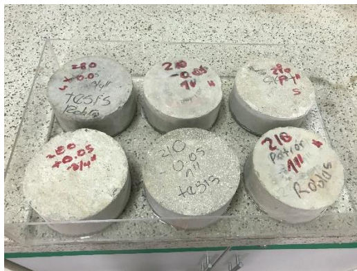
Figura 25. Muestras sumergidas en agua a una profundidad de 10mm.
