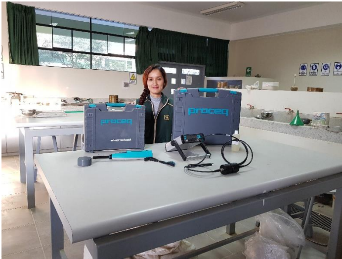
Equipo marca Proceq para la utilización del ensayo de esclerometría y pulso ultrasónico.
