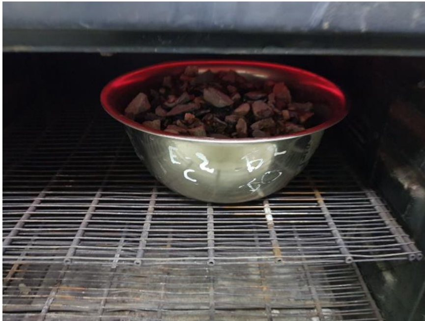
Figura 10. Agregado grueso puesto en el horno.
