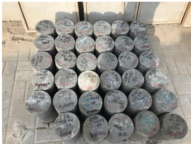
Figura 17. Probetas seleccionadas para realizar el ensayo de resistencia del concreto.
