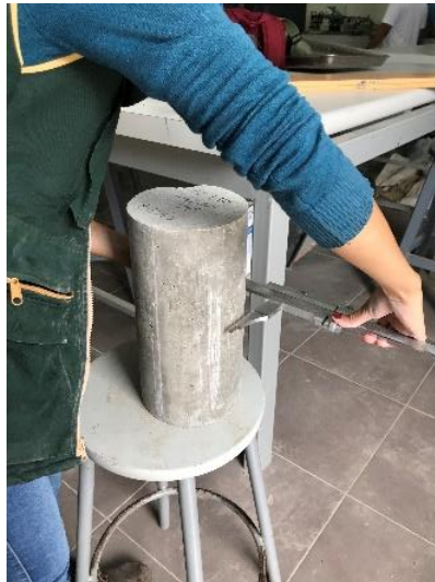
Figura 22. Medición del diámetro de las probetas.
