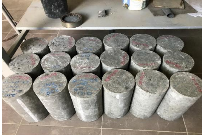
Figura 21. Probetas seleccionadas para determinar la densidad y contenido de vacíos.
