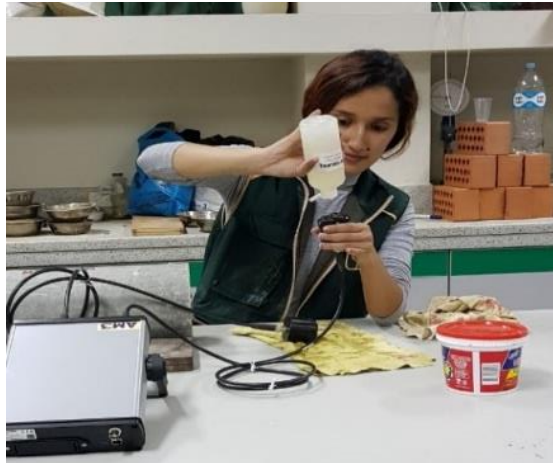
Figura 19. Colocando gel sobre el equipo de ultrasonido para realizar mediciones.
