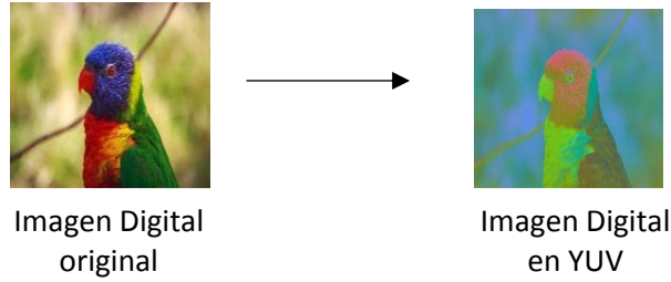
Ilustración 20- Conversión la Imagen Digital en RGB a YUV
