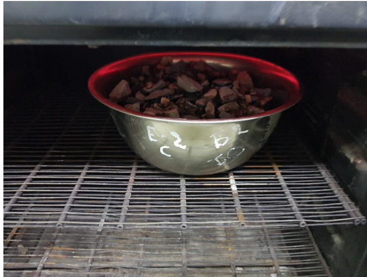
Figura 28. Muestra de agregado grueso secado al horno a 110^{\circ}\text{C} \pm 5^{\circ}\text{C} para estimar el contenido de humedad.
