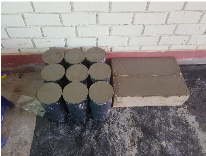
Vaciado de probetas y vigas
