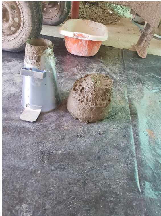
Figura 37. Medición del asentamiento del concreto.
