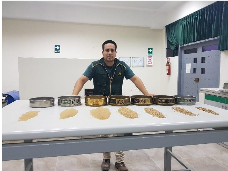
Figura 17. Muestra de agregado fino luego de haber sido tamizado sucesivamente por las mallas según NTP 350.001.
