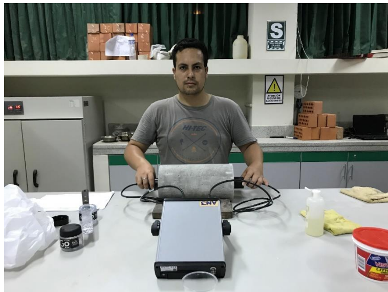
Figura 50. Toma de velocidad de pulso ultrasonido en probetas cilíndricas de 6"×12".
