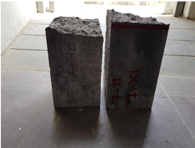
Viga después del ensayo de esfuerzo a flexión
