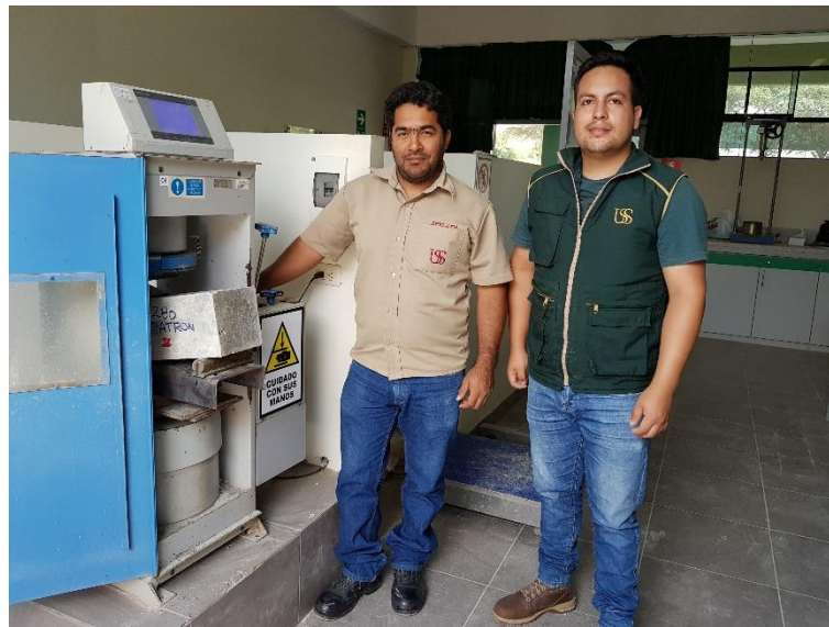
Figura 44. Técnico del Laboratorio de Materiales verificando el correcto desarrollo del ensayo para la determinación de la resistencia a la flexión del concreto.
