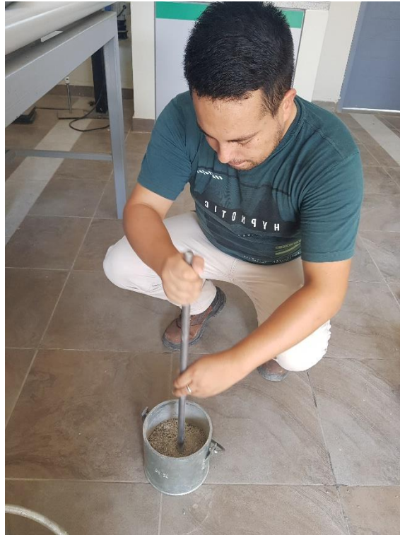
Figura 19. Proceso de compactación de agregado fino reciclado, goleándose 25 veces cada capa una con la barrilla compactadora.
