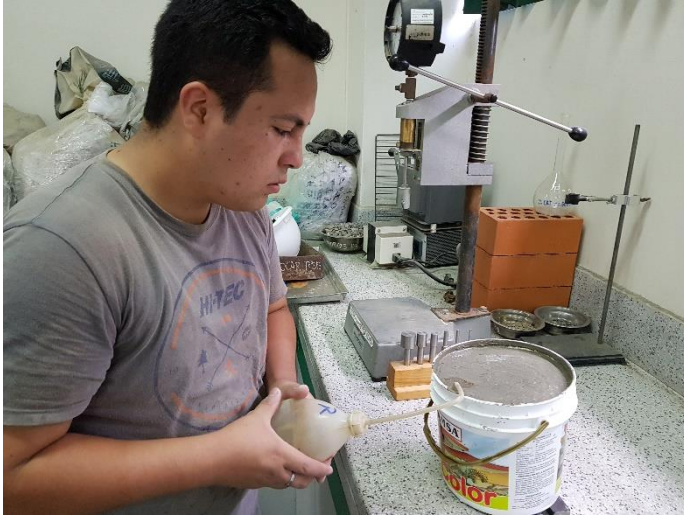
Extracción de volúmenes de agua producto de la exudación del concreto
