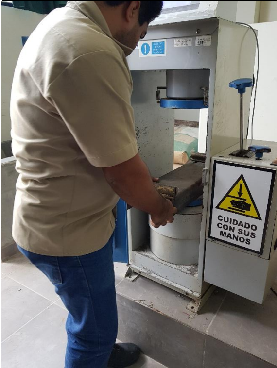
Técnico del Laboratorio colocado la base para el ensaye de vigas
