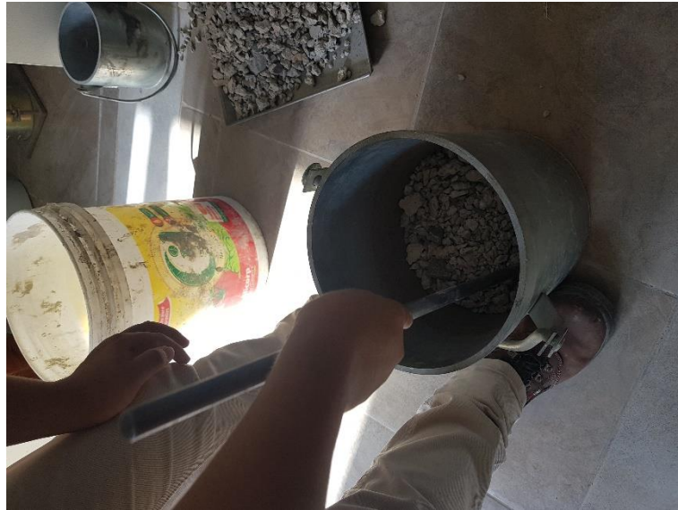
Figura 26. Compactación del agregado grueso reciclado en el molde metálico para la medición del peso compactado húmedo.
