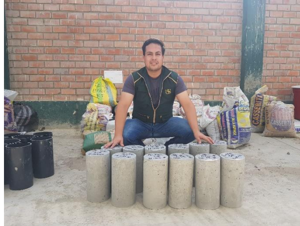
Figura 33. Probetas de muestra a la edad de 7 días para evaluación de la resistencia crítica de diseño f'_{cr} .
