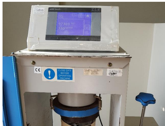
Figura 43. Lectura de la carga aplicada sobre la probeta para determinar el esfuerzo a la compresión.
