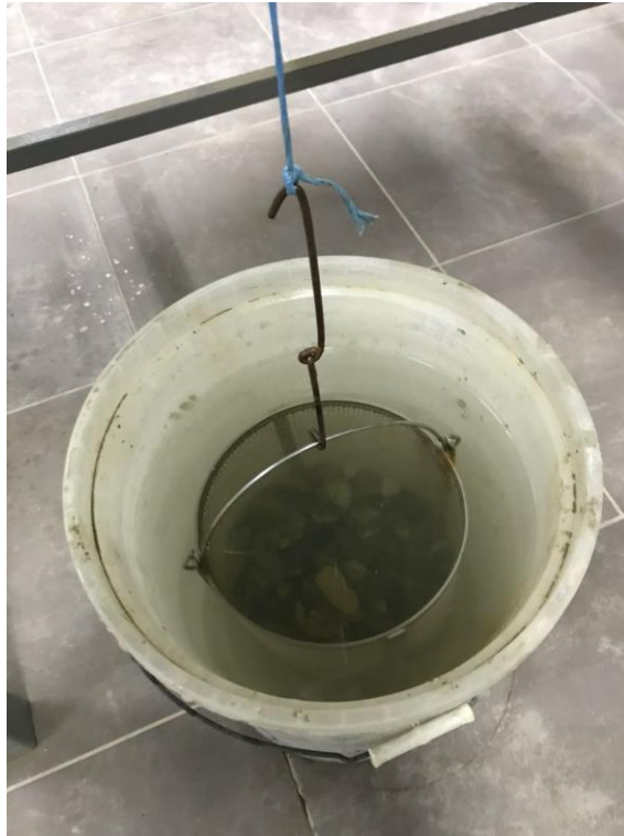
Figura 27. Muestra de agregado grueso de la cantera Tres Tomas, sumergido en la canastilla metálica para el cálculo del peso sumergido.
