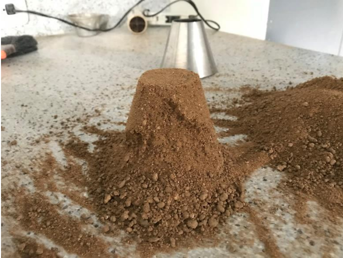
Verificación del grado de saturación del agregado fino para la estimación del peso específico
