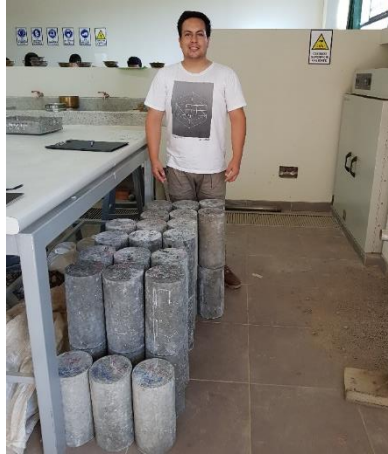
Figura 42. Elementos de concreto, seleccionados para determinar su resistencia a la compresión.
