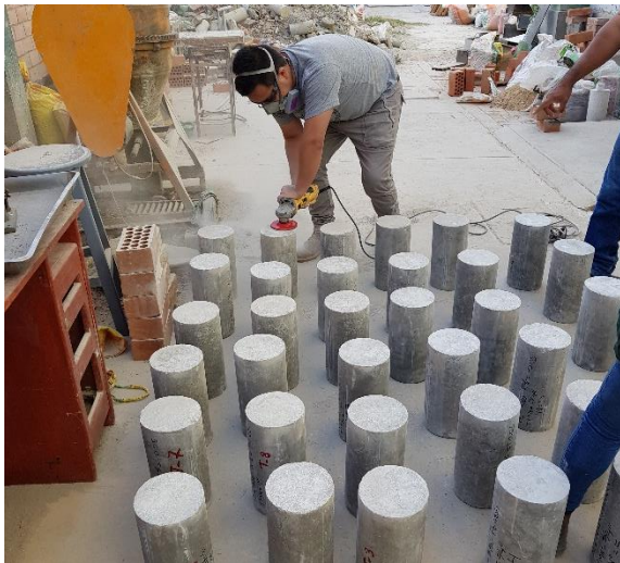
Pulido de las caras de las probetas para la aplicación del número de rebote
