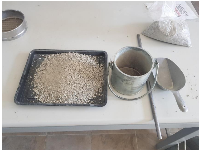
Figura 18. Muestra de agregado fino reciclado para el ensayo de peso unitario suelto.
