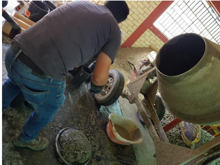
Figura 34. Elaboración de mezclas definitivas para la elaboración de elementos de concreto simple para ser estudiados en estado fresco y endurecido.
