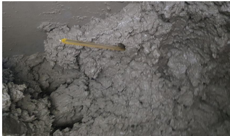
Figura 38. Medición de la temperatura de mezclas.
