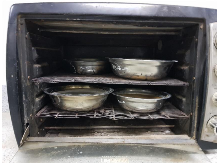
Figura 22. Muestras de agregado fino reciclado y agregado fino natural puestas en horno a 110^{\circ}\text{C} \pm 5^{\circ}\text{C} .
