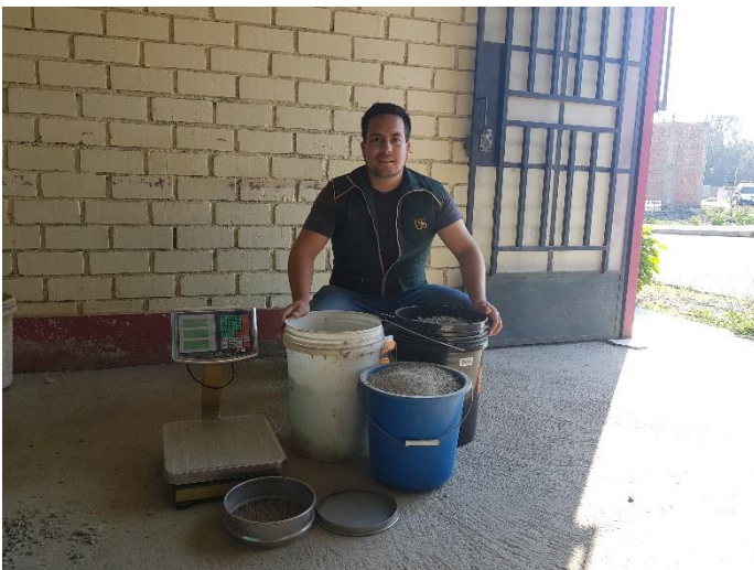
Pesado de materiales para una tanda de concreto, elaborado in situ
