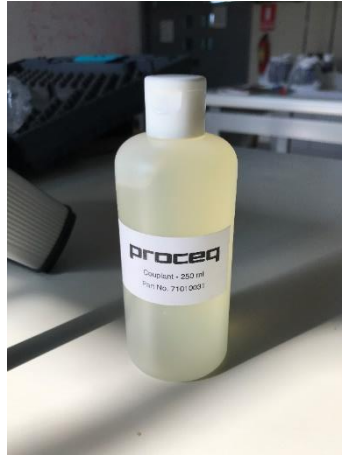
Figura 48. Gel acoplante para transductores de la marca Proceq.
