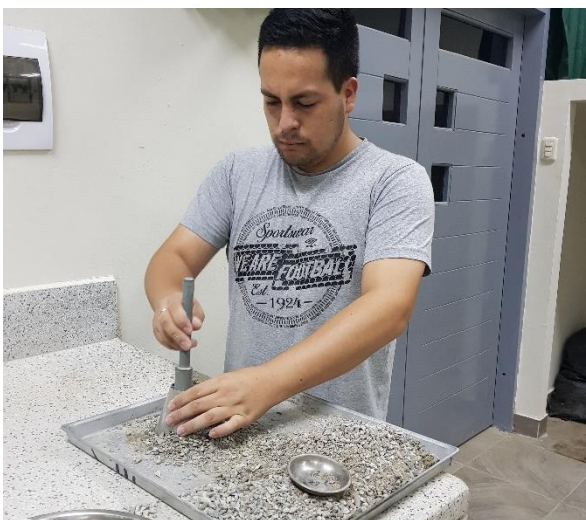
Compactación en la pieza cónica para verificar el contenido de humedad de muestras saturadas para el peso específico.
