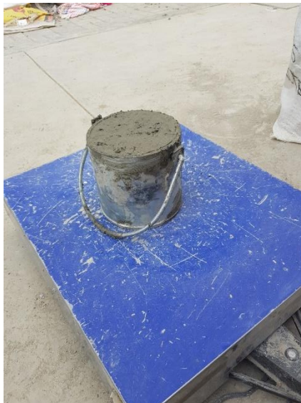
Figura 39. Medición del peso unitario del concreto fresco.
