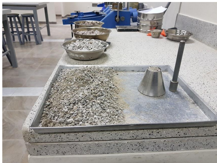
Figura 20. Colocación del agregado fino reciclado dentro del molde cónico.
