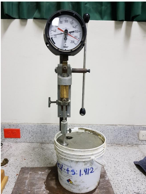
Muestra ensayada en el Penetrómetro para la estimación del tiempo de fraguado
