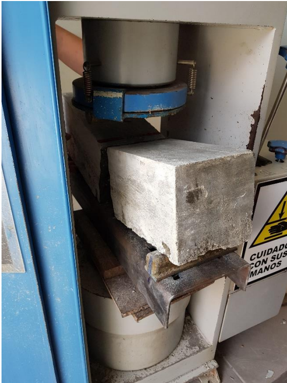
Viga después del fallo de aplicar una carga en su eje central
