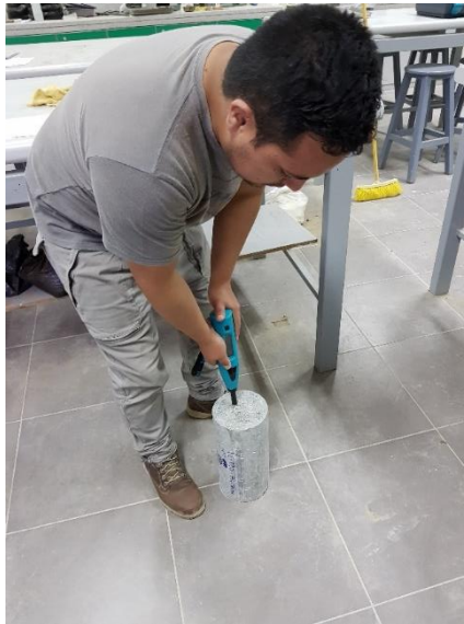
Figura 46. Procedimiento de obtención del número de rebote del concreto, procurando la verticalidad del instrumento.
