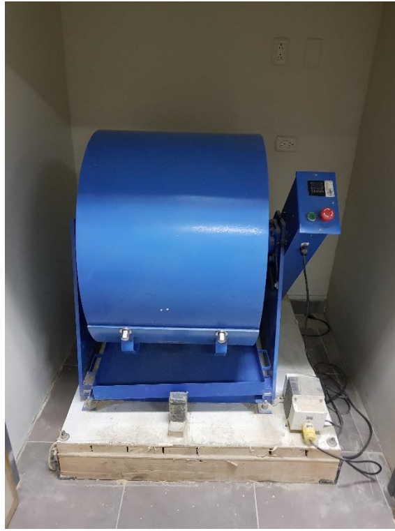
Figura 29. Máquina de los Ángeles para determinar la resistencia a la degradación de los agregados gruesos.
