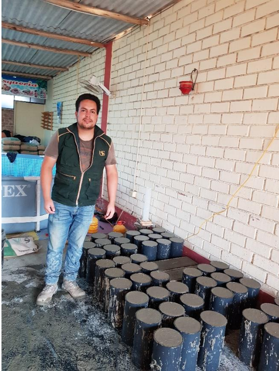
Vaciado de varias probetas y vigas
