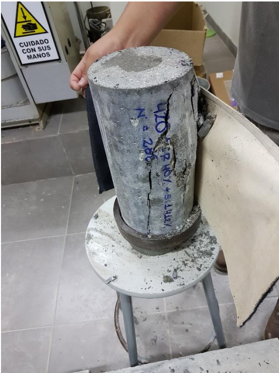
Elemento luego de haberse sometido a esfuerzos a compresión
