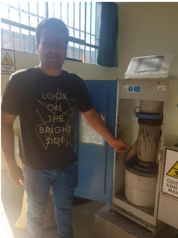
Rotura de probetas de muestra.
