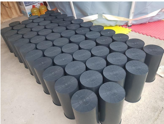
Moldes de PVC para la elaboración de testigos de 6" × 12".
