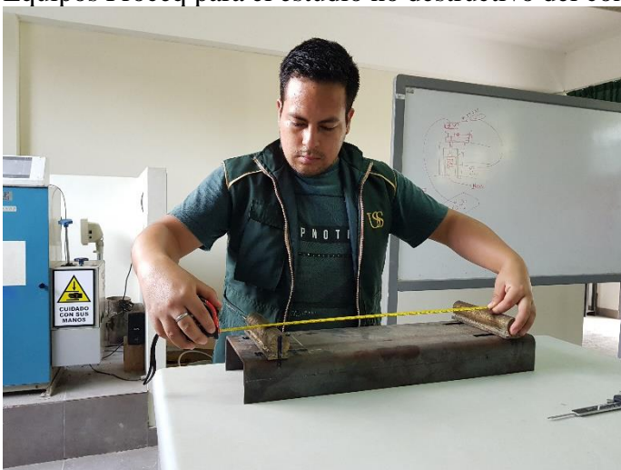
Medida de la distancia entre los apoyos para el ensaye de vigas
