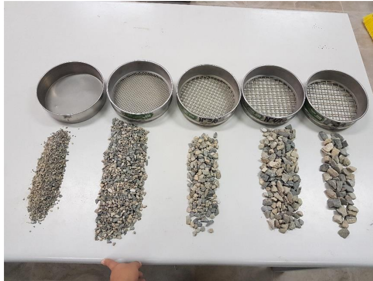
Figura 24. Tamizado de agregado grueso de la cantera Tres Tomas – Ferreñafe.
