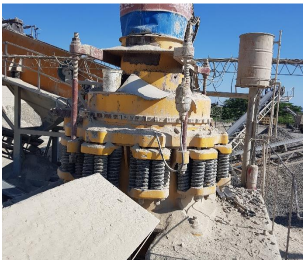
Tambor principal de la chancadora, usado para tritura el concreto reciclado.
