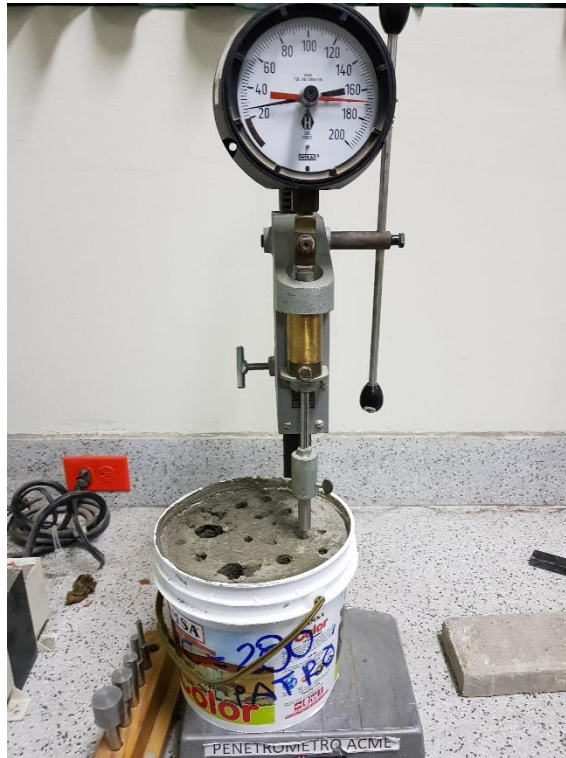
Figura 40. Uso de Penetrómetro para determinar el esfuerzo a la penetración en diferentes intervalos de tiempo.
