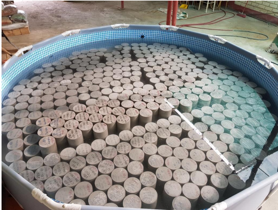
Figura 36. Curado de 324 probetas y 54 vigas que representan la muestra de esta investigación.
