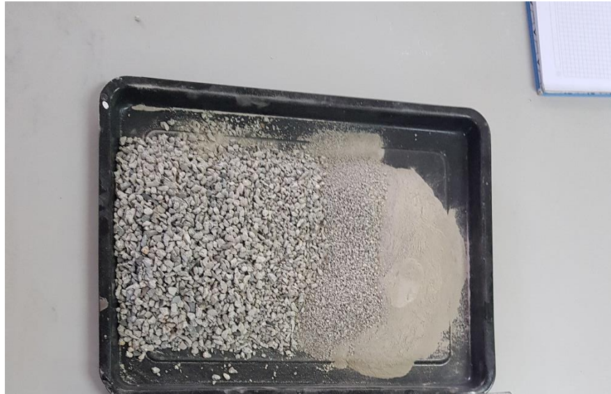
Figura 23. Muestra significativa de agregado fino reciclado para ser analizada por difracción por rayos X.
