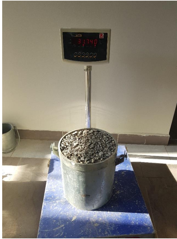
Figura 25. Medición del peso suelto húmedo de concreto reciclado grueso.
