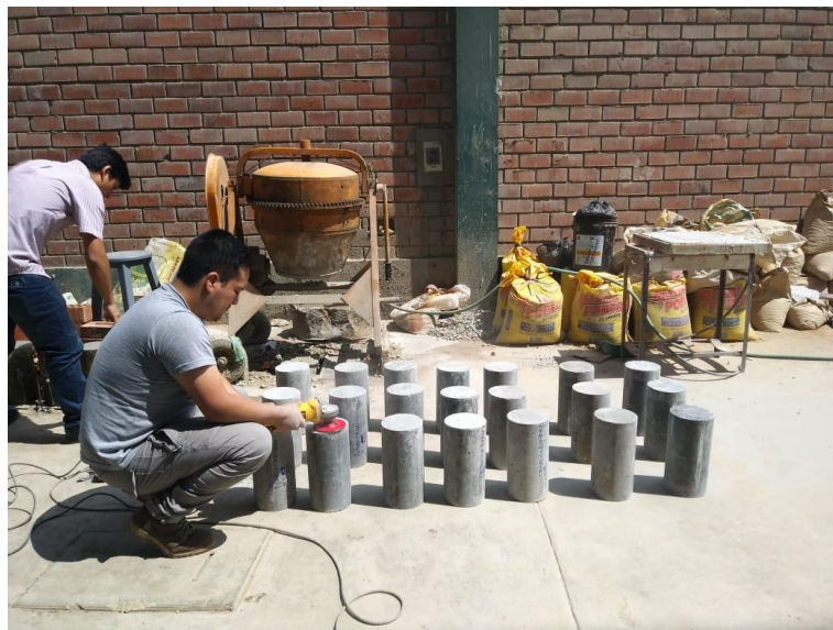
Figura 45. Proceso de pulido de las caras de probetas a ser ensayadas.
