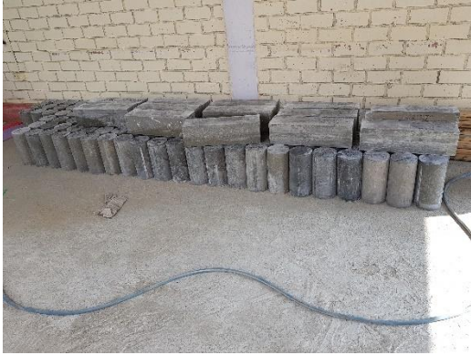
Elementos preparados para aplicar los ensayos para concreto endurecido
