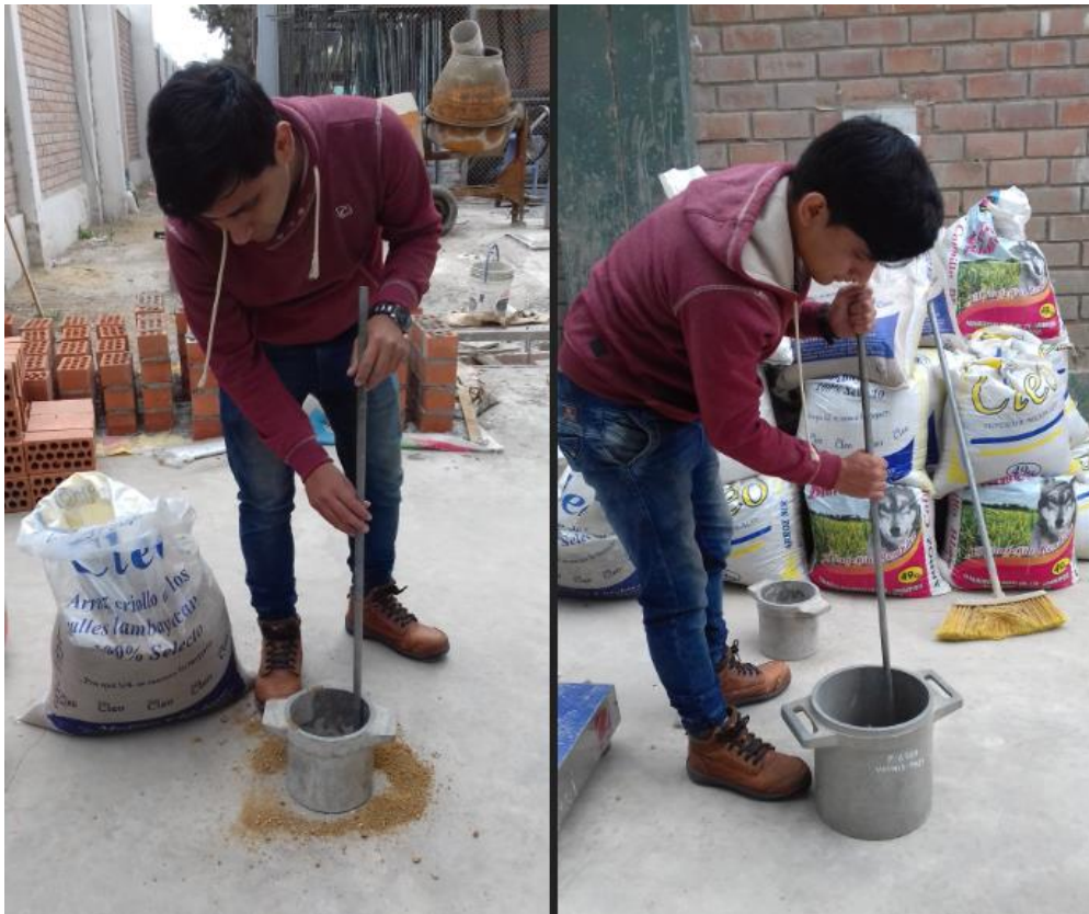
Figura 10. Ensayo del peso unitario compactado del agregado fino y grueso.
