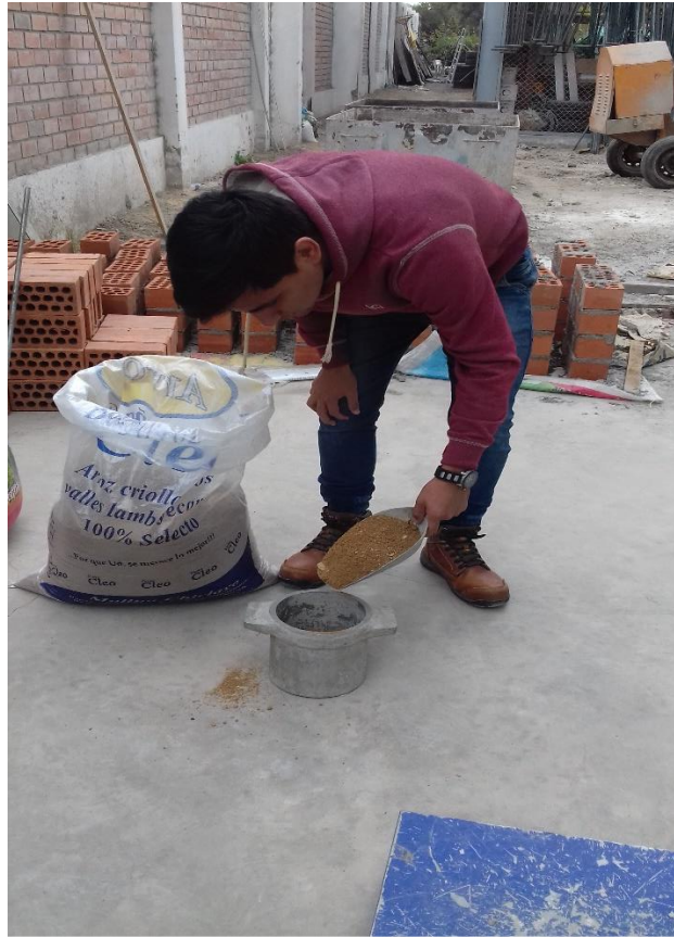
Figura 67. Peso unitario suelto del agregado grueso.
