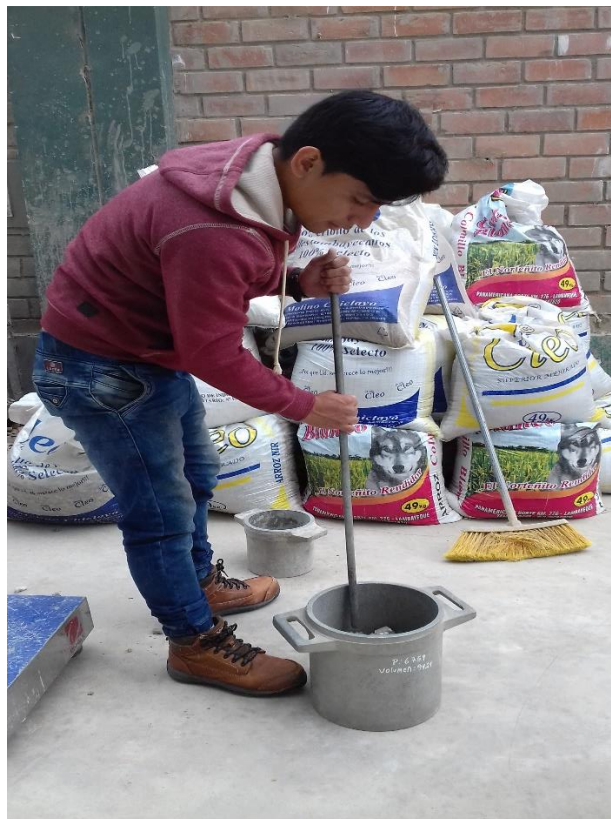
Figura 68. Peso unitario compactado del agregado grueso.
