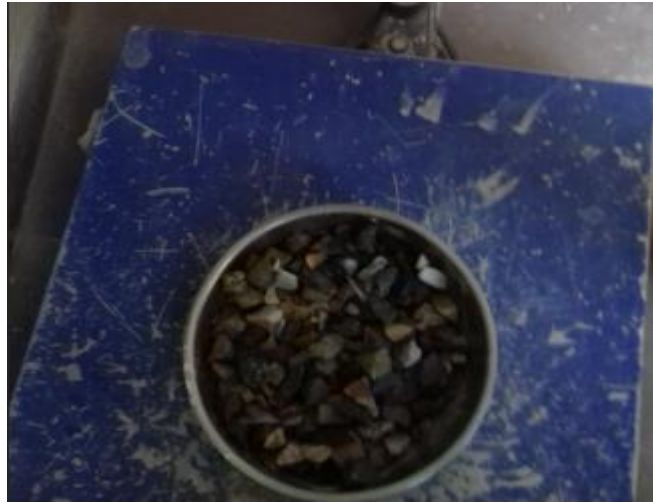
Figura 12. Ensayo del peso específico y absorción del agregado grueso, muestra del agregado en estado superficialmente seco.
