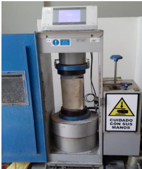
Figura 19. Ensayo normalizado para de terminación de la resistencia a la compresión del concreto a diferentes edades
