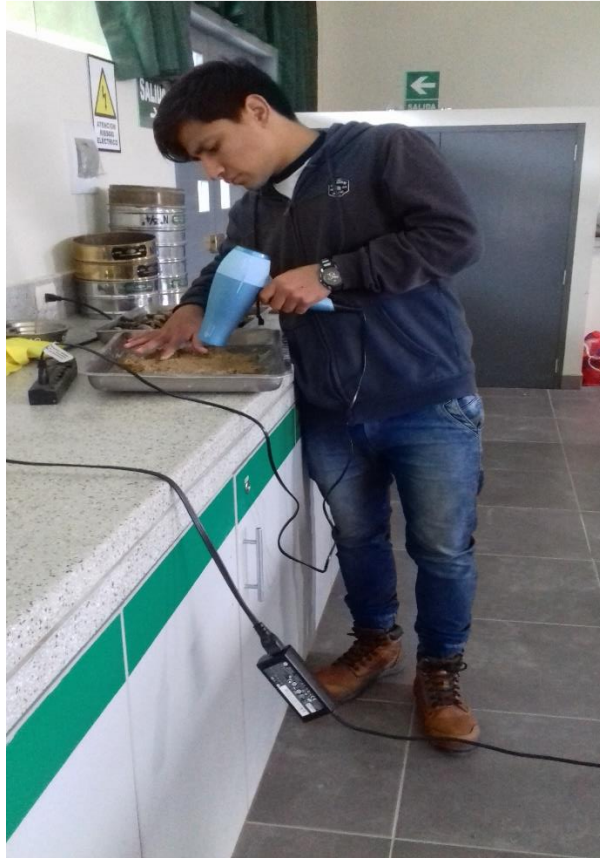
Figura 69. Peso específico y absorción del agregado fino.
