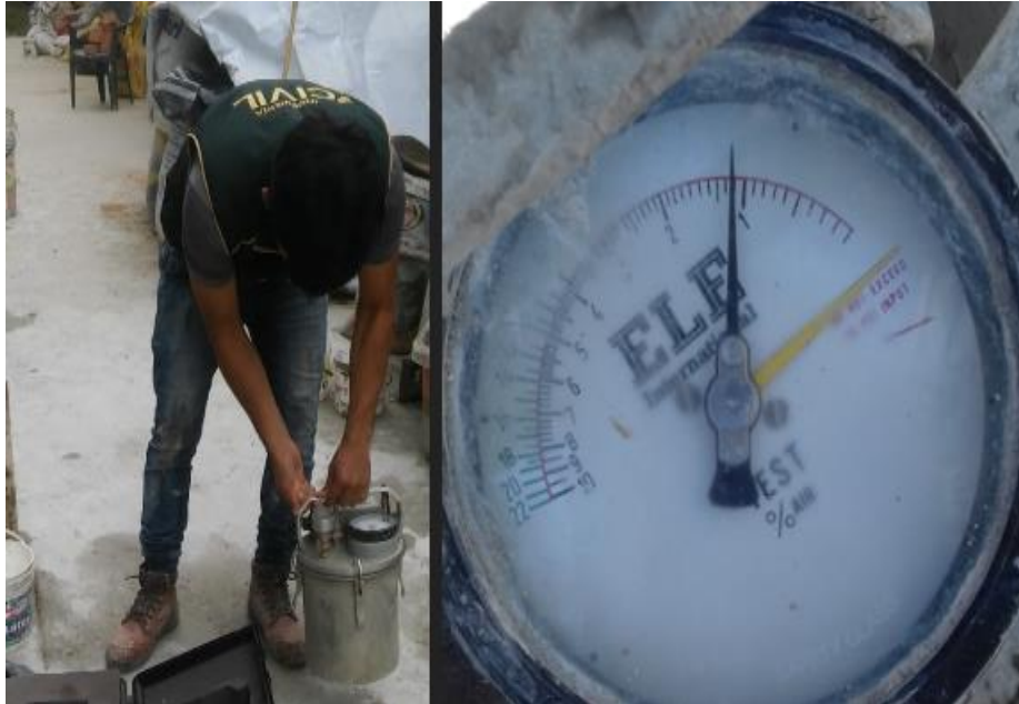
Figura 18. Ensayo de contenido de aire, se observa en el medidor que el dial marca un porcentaje de aire
