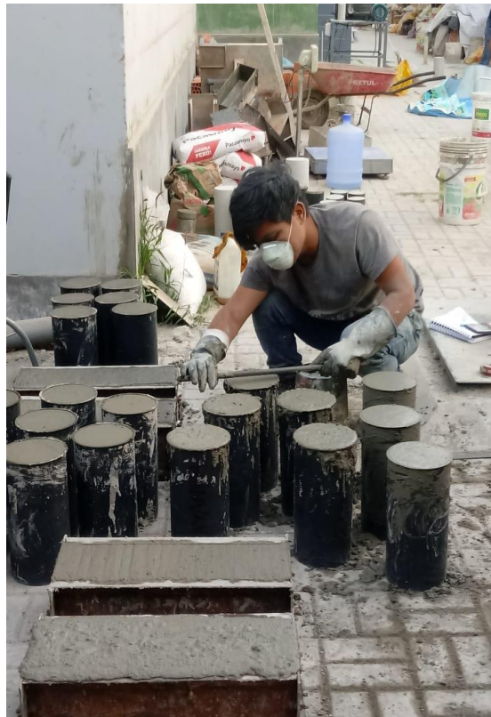
Figura 74. Llenado de probetas y vigas de concreto.
