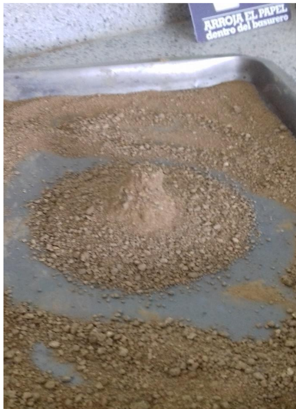
Figura 70. Muestra del agregado fino superficialmente seca.
