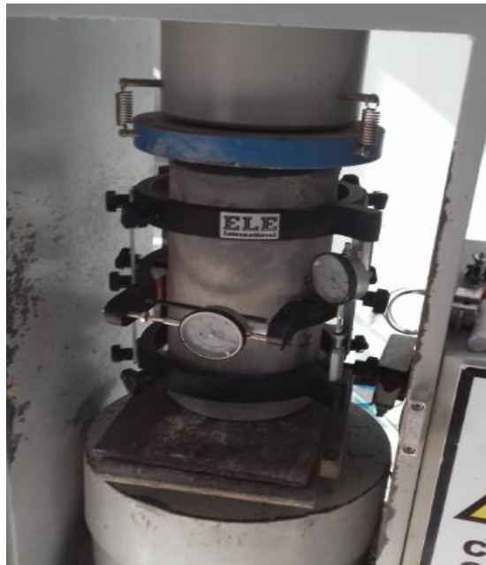
Figura 22. Ensayo del método de prueba estándar para módulo estático de la relación de Poisson y la elasticidad del hormigón en compresión
