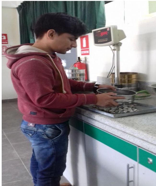
Figura 65. Análisis granulométrico de los agregados.
