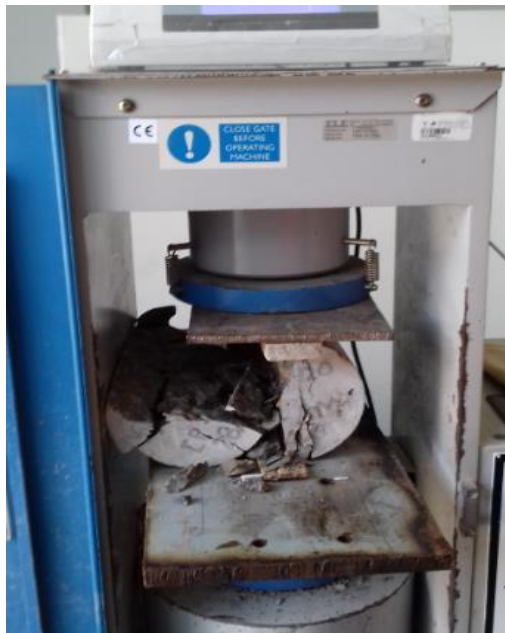
Figura 20. Método de ensayo normalizado para la determinación de la resistencia a tracción simple del concreto, se observa que la probeta de concreto tiene un tipo de fractura columnar
