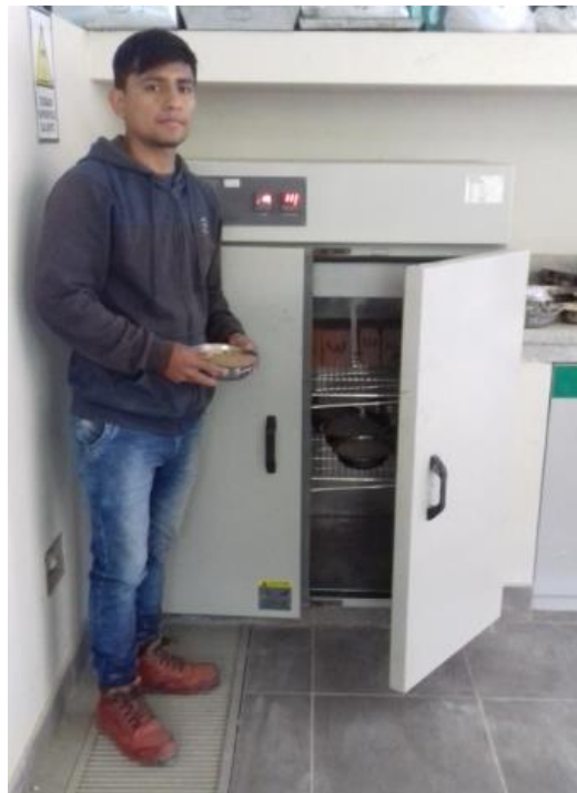
Figura 8. Ensayo de contenido de humedad, muestra llevada al horno con una temperatura de 110^{\circ} \pm 5 °C por un tiempo de 24 horas.
