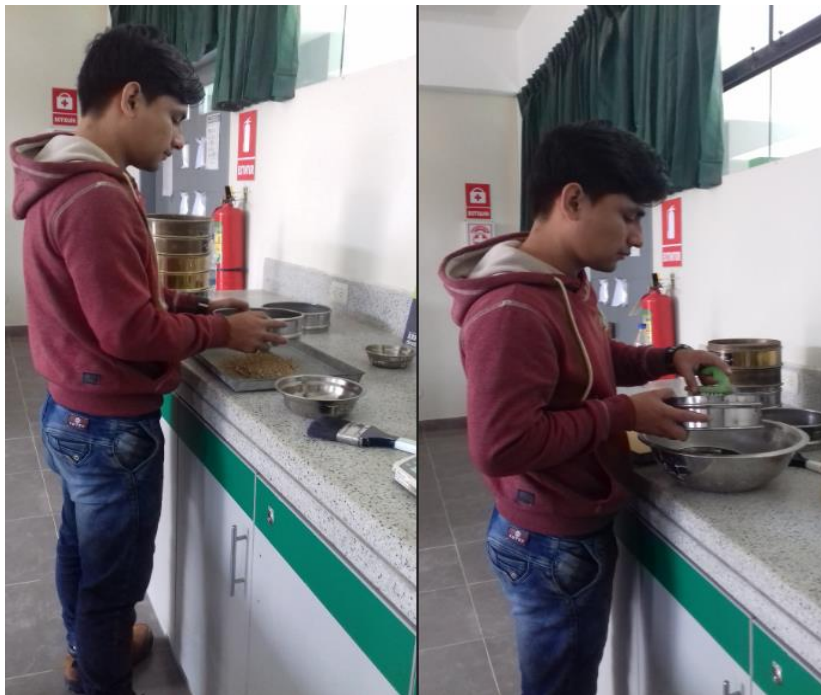
Figura 7. Ensayo de análisis granulométrico del agregado fino y grueso
