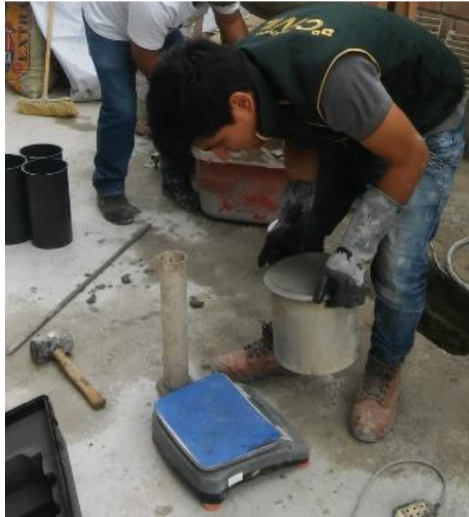
Figura 17. Ensayo para determinar el peso unitario del concreto, momento en donde se procede a pesar el molde cilíndrico más la muestra del concreto.
