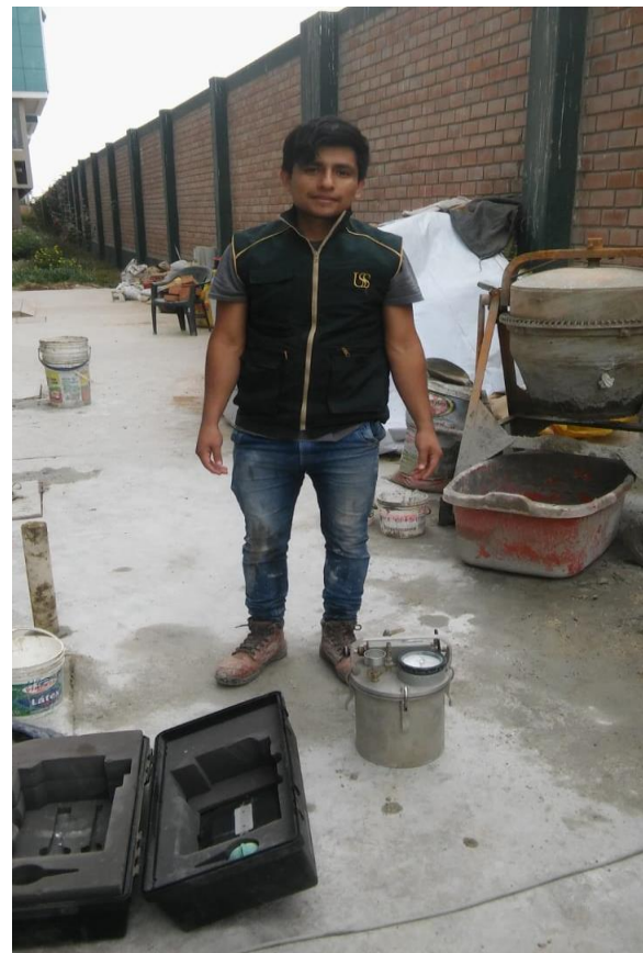
Figura 72. Ensayo de contenido de aire del concreto.
