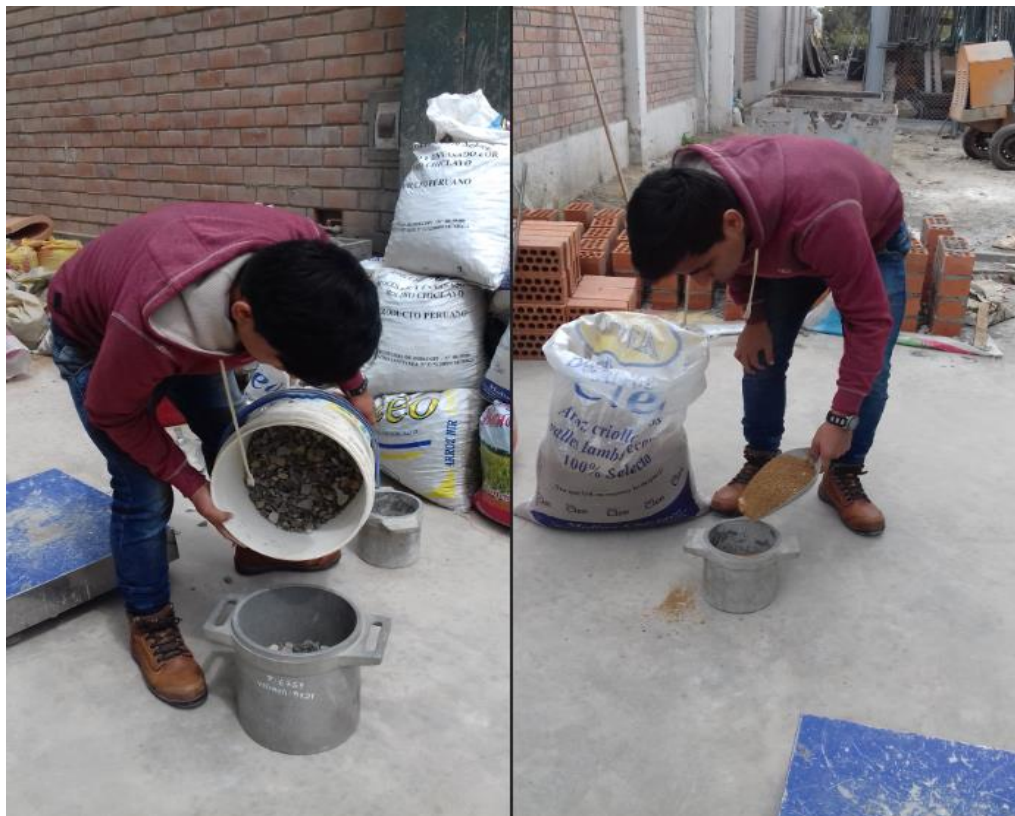
Figura 9. Ensayo del peso unitario suelto del agregado fino y grueso.
