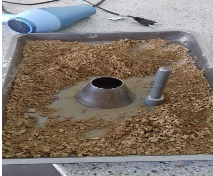
Figura 11. Ensayo del peso específico y absorción del agregado fino, muestra del agregado en estado superficialmente seco
