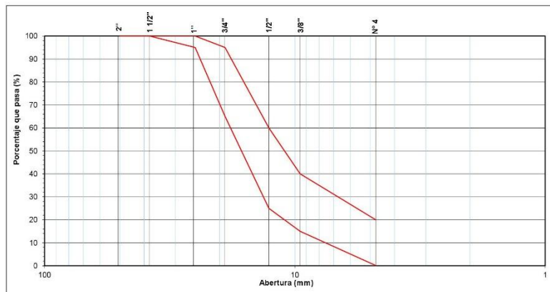
CURVA GRANULOMÉTRICA AGREGADO GRUESO
