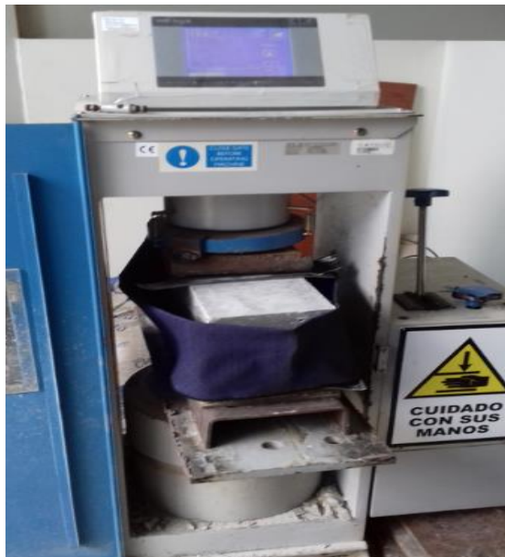
Figura 21. Método de ensayo para determinar la resistencia a la flexión del concreto en vigas simplemente apoyadas con cargas en el centro del tramo.
