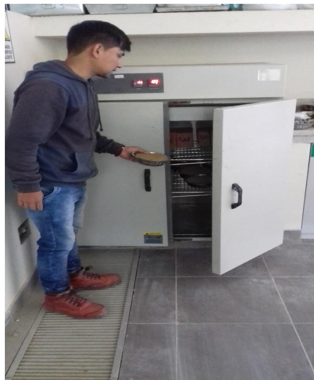
Figura 66. Contenido de humedad del agregado.
