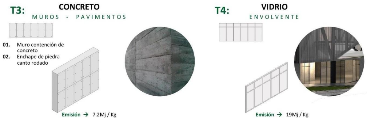
Figura 123: Esquema de emisión de Mj/kg del Concreto y Vidrio.
