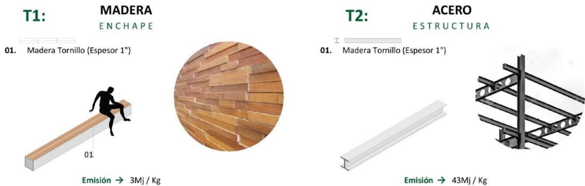
Figura 122: Esquema de emisión de Mj/kg de la Madera y Acero.
