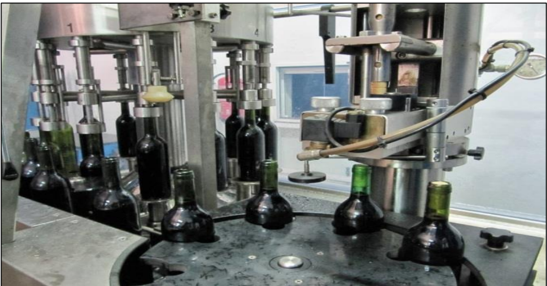
Figura 10. Máquina encorchadora. Fuente: Urbina Vinos blog, 2013.
