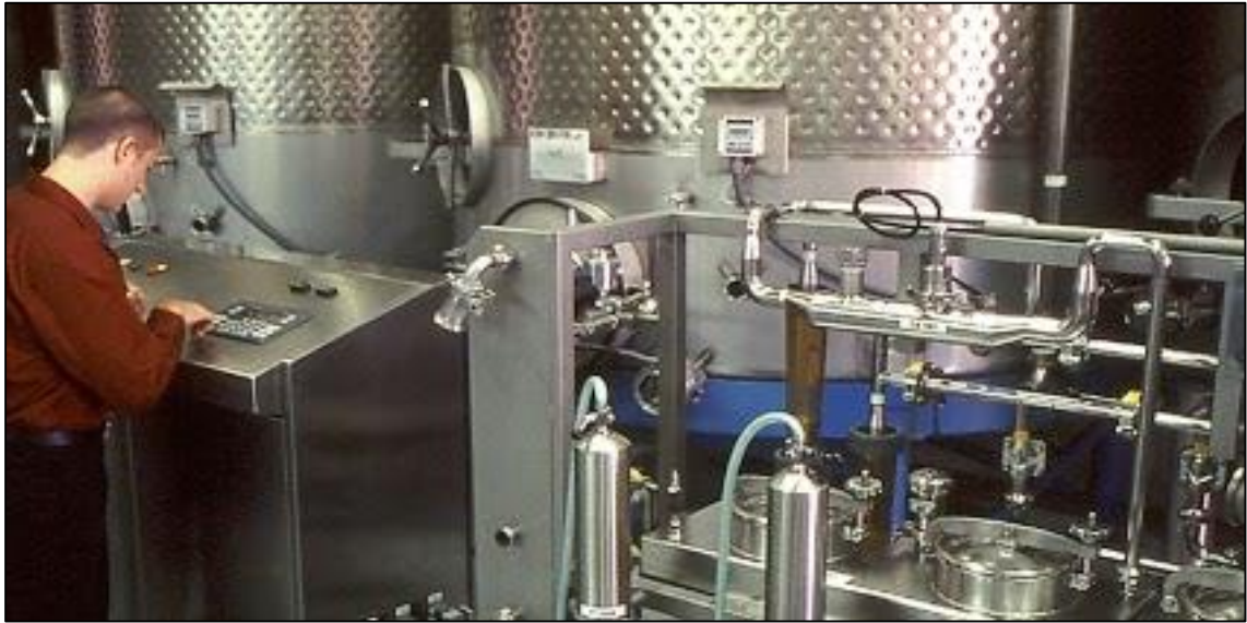
Figura 6. Centrifugación del vino. Fuente: Urbina Vinos blog, 2013
