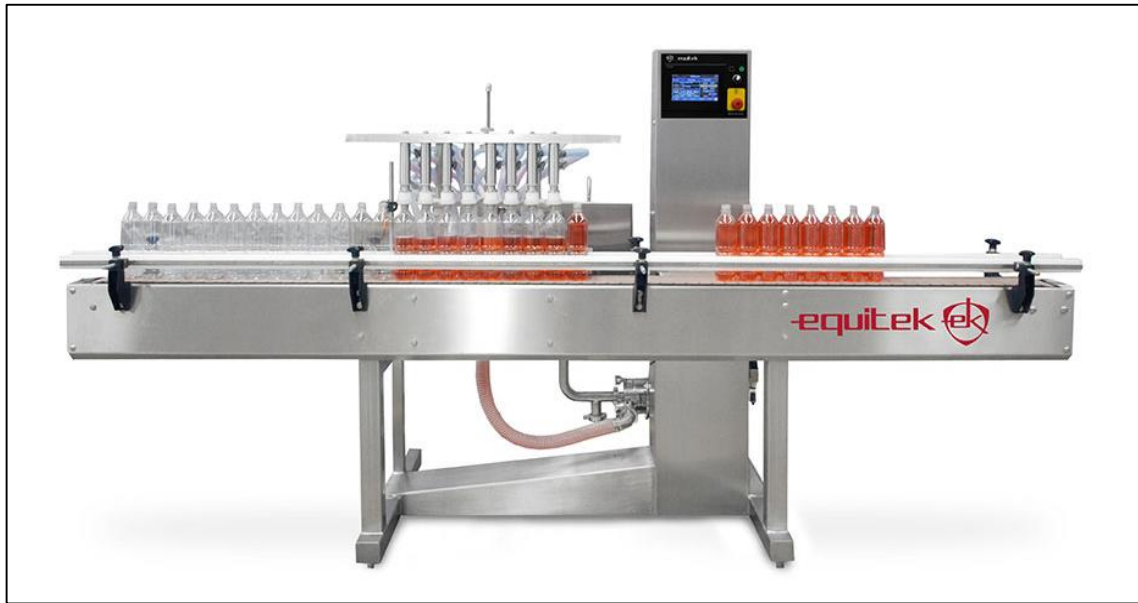
Figura 21. Máquina envasadora lineal Equitek serie DNL. Fuente: Equitek, 2016.
