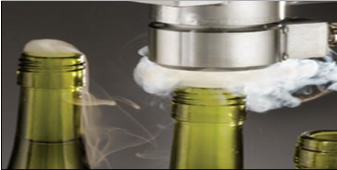
Figura 9. Embotellado con gotas de Nitrógeno. Fuente: Indura, 2017.
