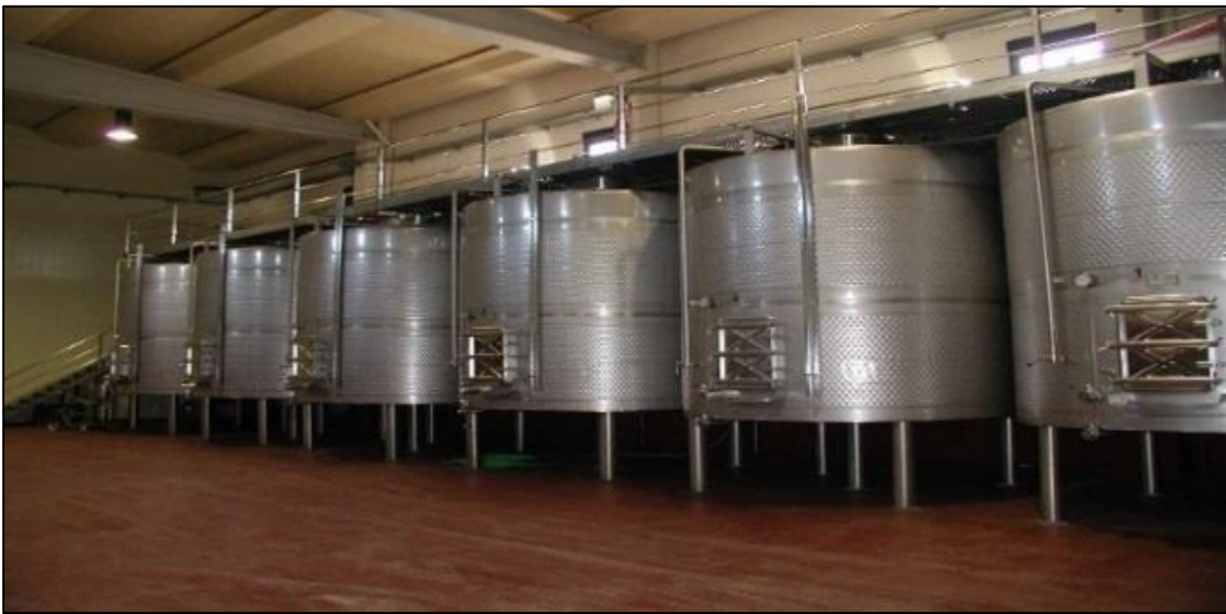
Figura 5. Bodega moderna de Fermentación en tanques de acero inoxidable.
