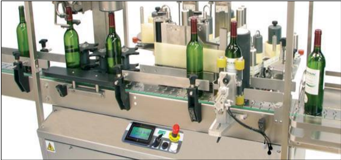
Figura 12. Máquina etiquetadora de envases de vino. Fuente: Albeniz, 2016.
