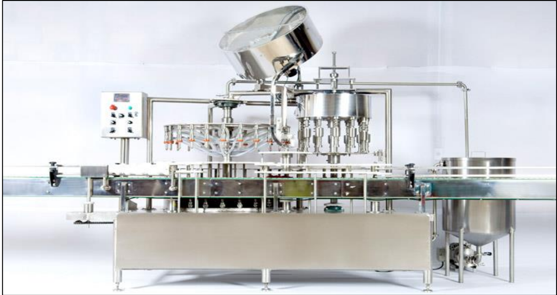
Figura 22. Máquina envasadora rotativa WORKERS modelo WK-RT 24-8.
