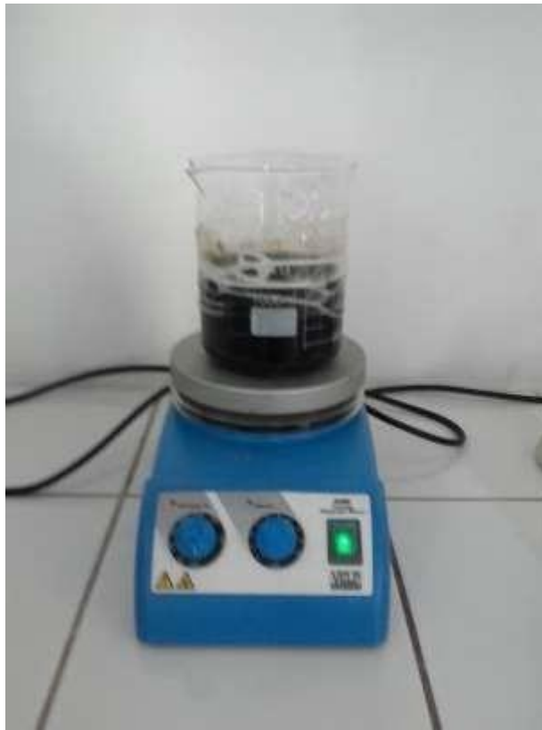
Figura 3: Agitación de la muestra a través de un agitador magnético. Fuente: Elaboración propia
