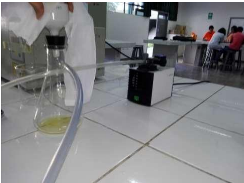
Figura 6: Separación de \kappa y \lambda carragenanos por filtrado al vacío Fuente: Elaboración propia
