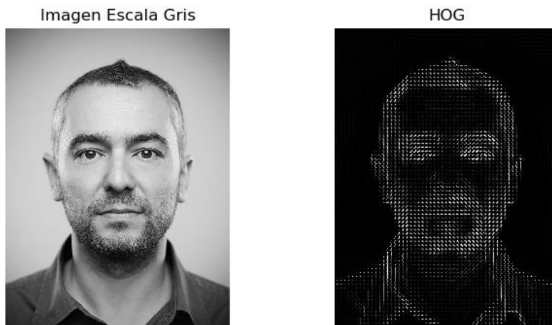
Figura 22: Transformación de imagen en escala de gris al descriptor HOG Fuente: Elaboración propia
