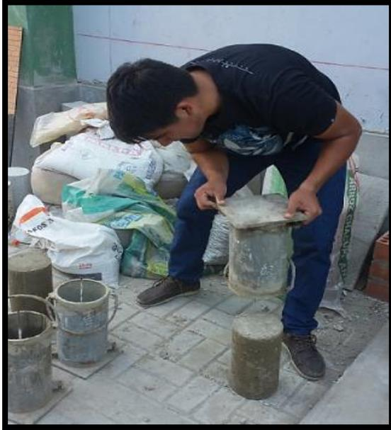
**Foto 2 -** Desencofrado de concreto
