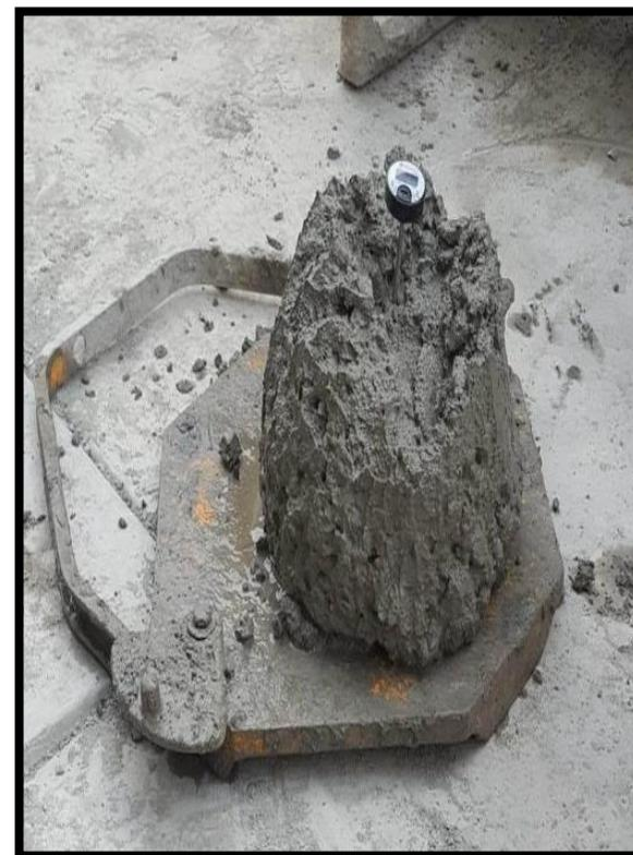
**Foto 3** – Medición de temperatura en la mezcla de concreto
