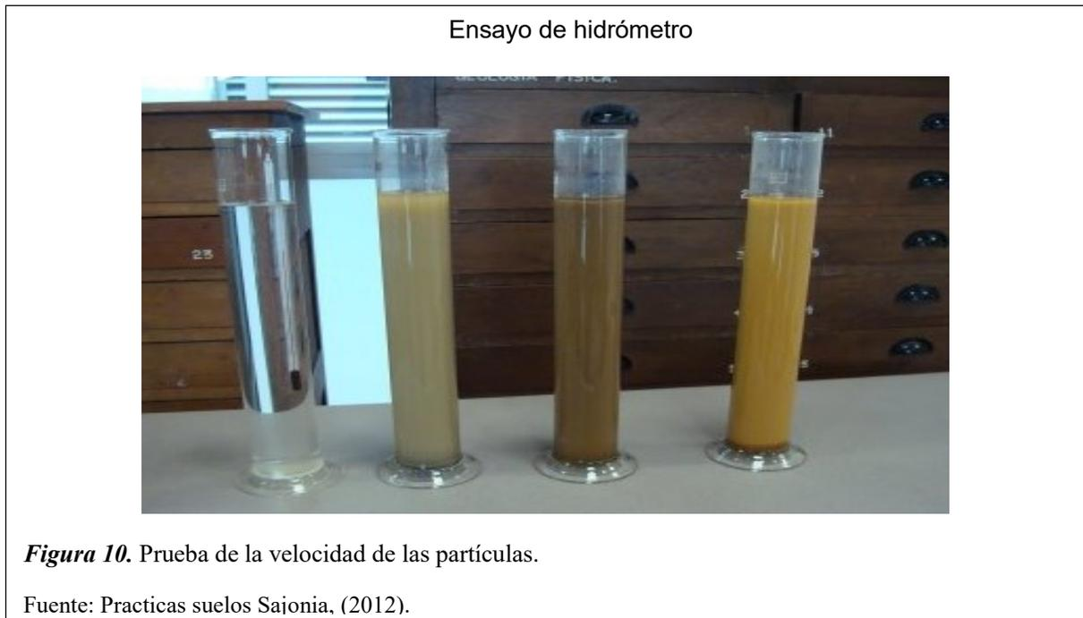
El tamaño aproximado de la muestra que se debe usar para el análisis por el hidrómetro varía con el tipo de suelo que va a ser ensayado. La cantidad requerida para suelos arenosos es de 75 a 100 g y para limos y arcillas de 50 a 60 g (peso seco). El peso exacto de la muestra en suspensión puede ser determinado antes o después del ensayo. (Manual MTC, 2016).
