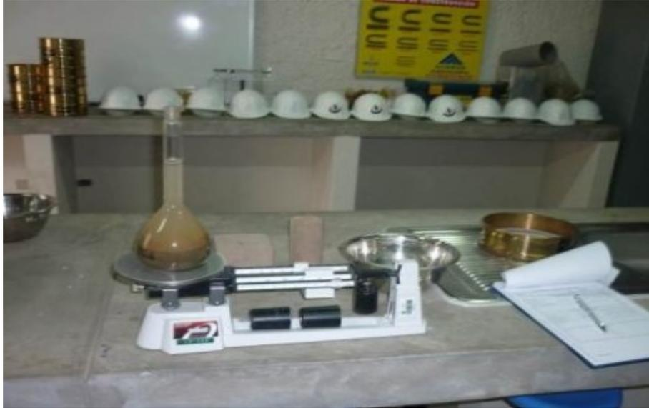
**Figura 9** . Ensayo para determinar el peso específico.
