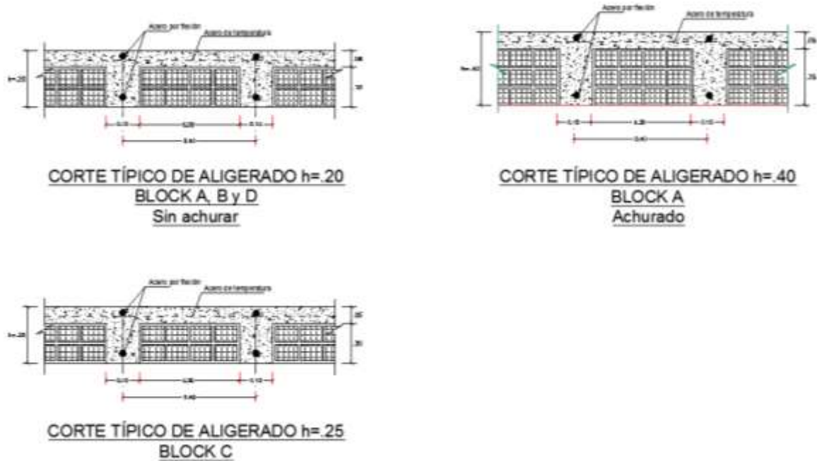
Figura 53: Aligerado en el modelo estructural. Fuente propia
