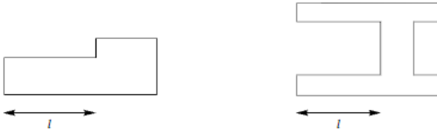
Figura 4: Relación largo - ancho en plantas tipo L y U. Fuente: Organización Panamericana de Salud
