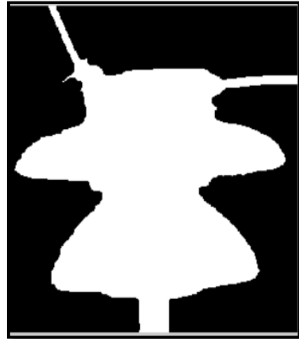
Figura 27: Imagen segmentada con Otsu. Fuente: Propia.
