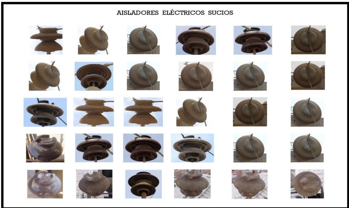
Figura 16: Imágenes de aisladores eléctricos en estado sucio, utilizados para realizar el test en los clasificadores. Fuente: Propia.
