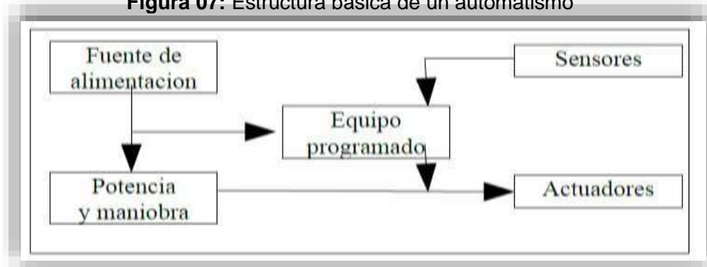
Figura 07: Estructura básica de un automatismo
