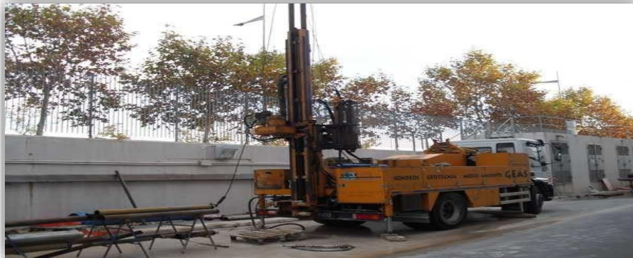
Ilustración 17: Penetrómetro Mecánico de Punta Cónica.
