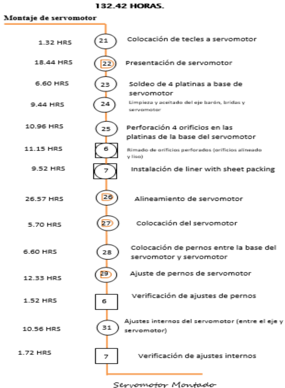
Figura Nro. 60 Proceso Montaje de Servomotor con la reducción de tiempo en la demora
