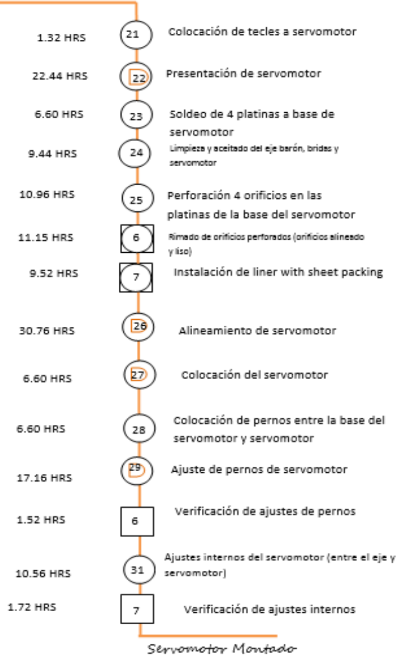
Figura Nro. 54 Proceso Montaje de Servomotor con las demoras
