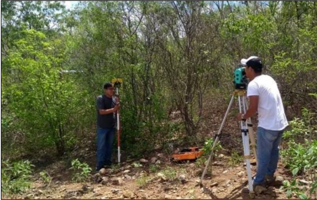
Figura 53. Levantamiento topográfico con estación total - Cantera La Loma
