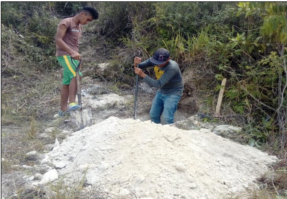
Figura 58. Excavación de calicata – cantera La Loma
