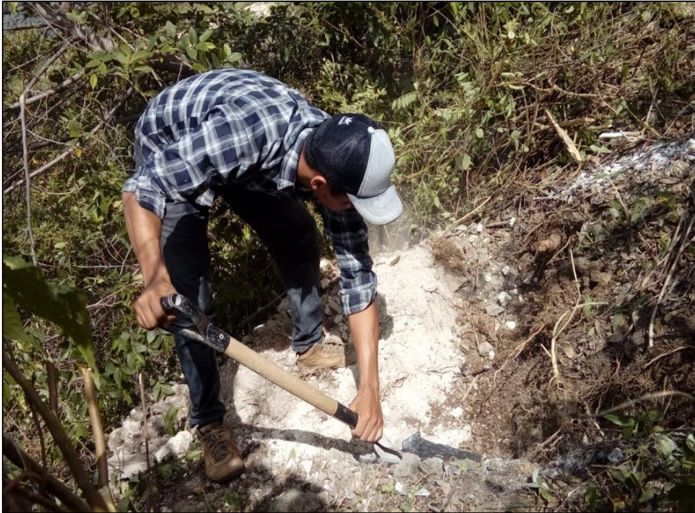
Figura 59. Excavación de calicata – cantera Las Paguillas
