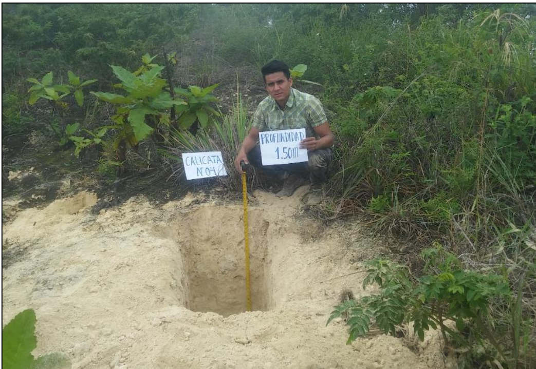
Figura 60. Medición de profundidad de calicata – cantera La Loma
